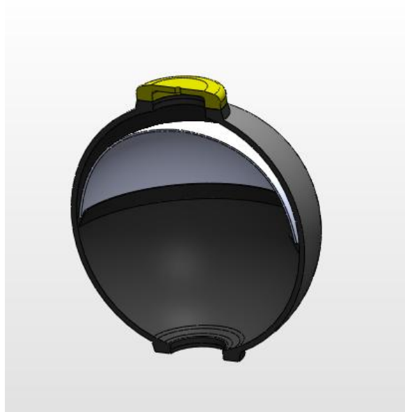
Figura 2.3 Tanque de propelente de geometria esférica e o diafragma (cinza claro) responsável pelo sistema de pressurização
