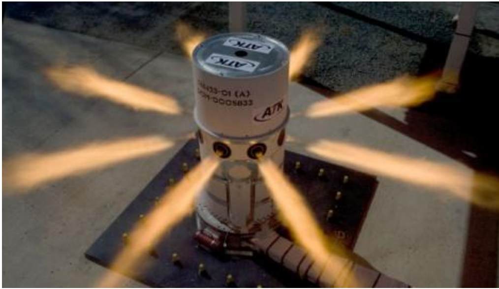
Figura 2.12 Sistema de controle de atitude desenvolvido pela ATK e Lockheed Martin para a NASA
