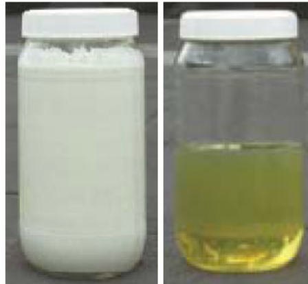
Figura 10 – Aparência do diesel emulsificado (esquerda) em comparação com o diesel convencional (direita). Fonte: SHELL, 2004, p.15.
