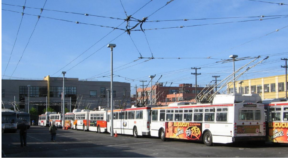
Figura 20 – Trólebus conectados a uma rede de fornecimento de energia. Fonte: RAPID TRANSIT PRESS, 2008.
