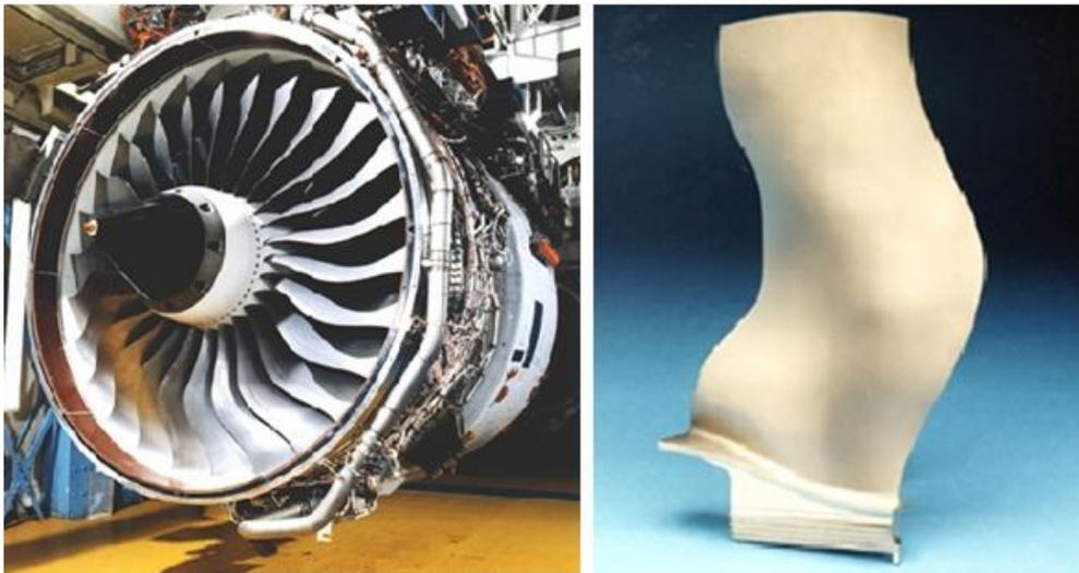
Figura 34- Palhetas de superliga a base de níquel utilizadas em turbinas de aeronaves (Msm, 2011).
