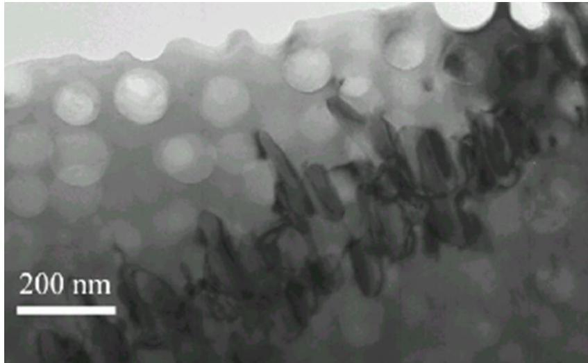
Figura 24- Micrografia Eletrônica de Transmissão mostrando uma pequena quantidade de partículas  $\gamma'$ , em forma esférica, na matriz  $\gamma$ . Observa-se também carbonetos do tipo  $M_{23}C_6$  ao longo do contorno de grão (Tancret *et al*, 2003).
