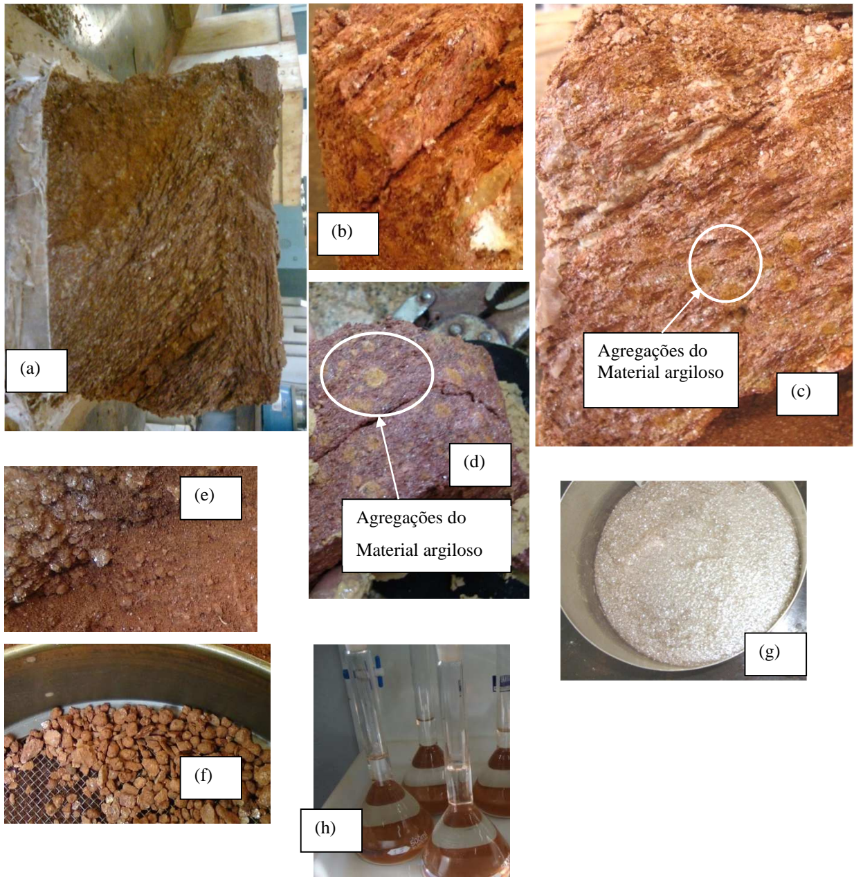
Figura 4.19 – Vista da complexidade de amostras indeformadas e detalhes em amostras deformadas do perfil de solo do CE-III.
