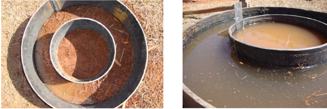
Figura 4.24 – Ensaio do infiltrômetro, utilizado no CE-III.
