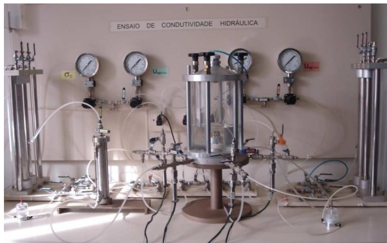
Figura 4.12 - Permeâmetro triaxial desenvolvido por Feuerharmel (2007). Foto Garcês (2010).
