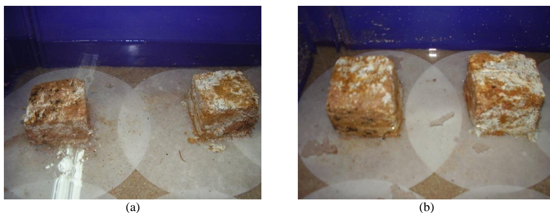
Figura 5.8 - Ensaio de desagregação do solo saprolítico da voçoroca Túnel: (a) Inundação imediata; (b) Inundação parcial.
