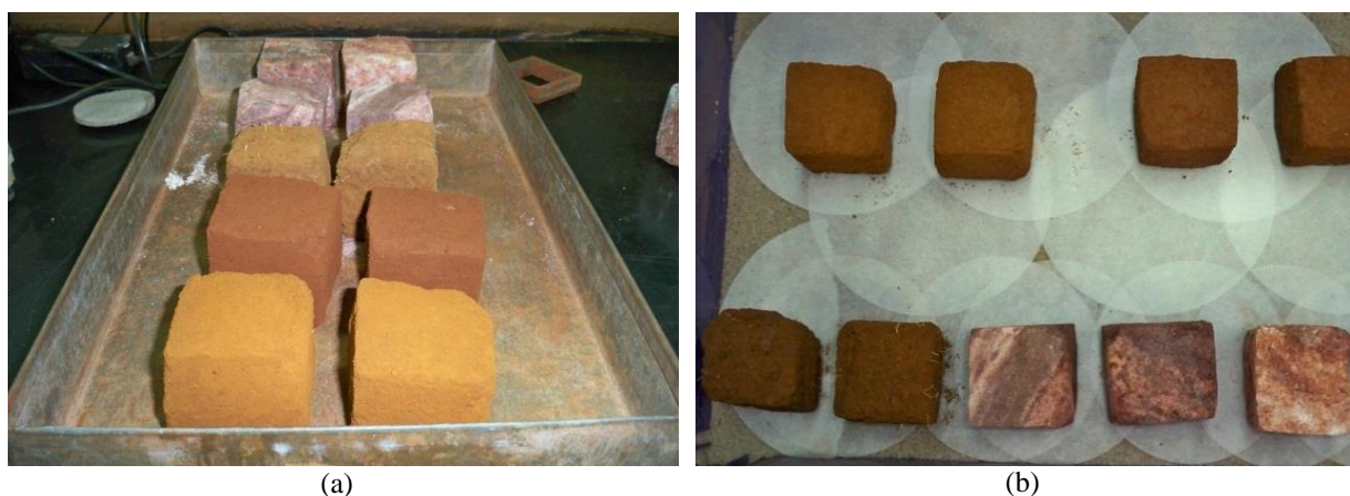
Figura 3.16 - Ensaio de desagregação: (a) Moldagem dos corpos de prova; (b) Preparação do tanque para receber as amostras.
