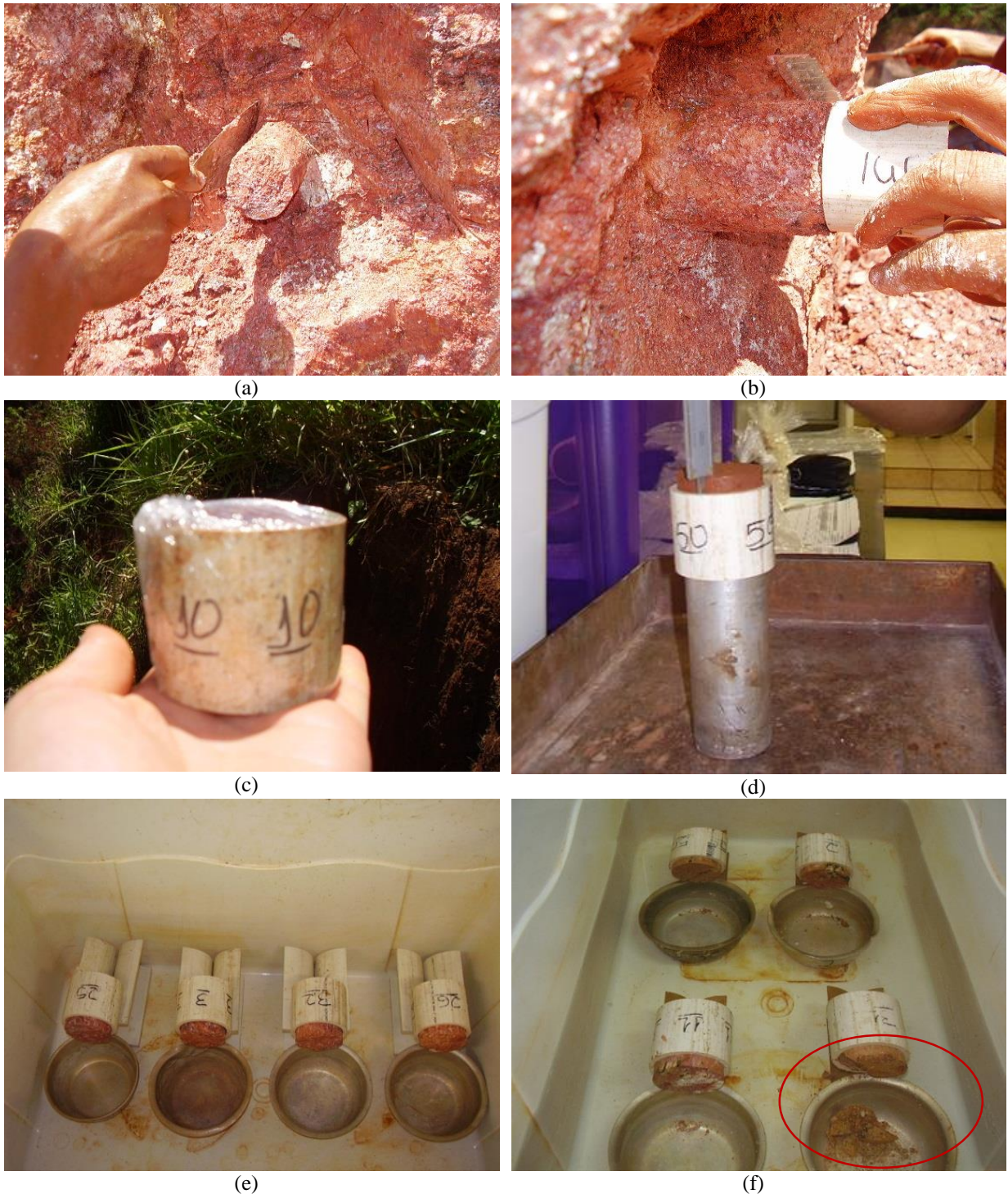
Figura 3.15 - Ensaio de perda de massa por imersão: (a) Moldagem do corpo de prova; (b) Cravação do cilindro; (c) Envolvimento da amostra em plástico filme; (d) Extração da amostra para realização do ensaio; (e) Organização das amostras para realização do ensaio; (f) Material despreendido acumulado na cápsula.
