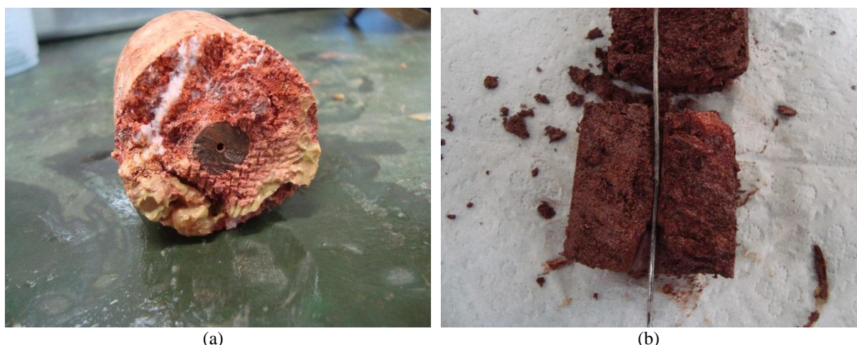
Figura 3.18 - Ensaio de Pinhole: (a) Furo axial realizado no Corpo de prova; (b) Corpo de prova de prova aberto ao final do ensaio.
