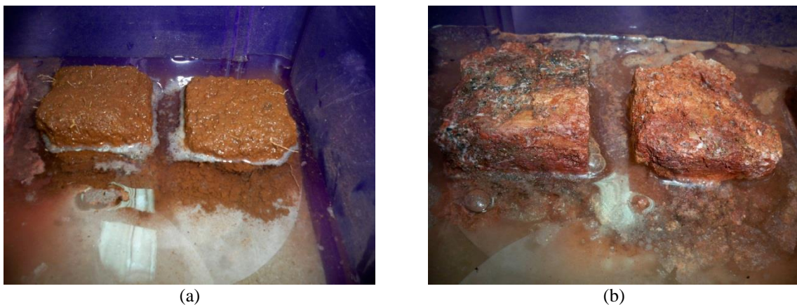
Figura 5.32 - Ensaio de desagregação dos solos da voçoroca Geovane Braga (a) Inundação parcial do solos laterítico; (b) Inundação parcial do solo saprolítico.
