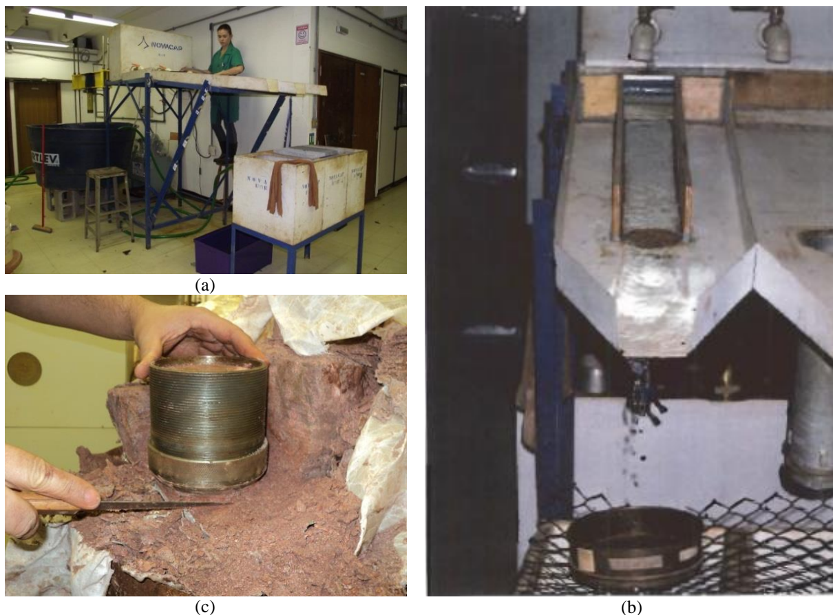
Figura 3.17 - Ensaio de Inderbitzen: (a) Visão geral do equipamento de inderbitzen; (b) Rampa do equipamento de Inderbitzen modificada por Santos (1997); (c) Moldagem do corpo de prova em bloco indeformado.
