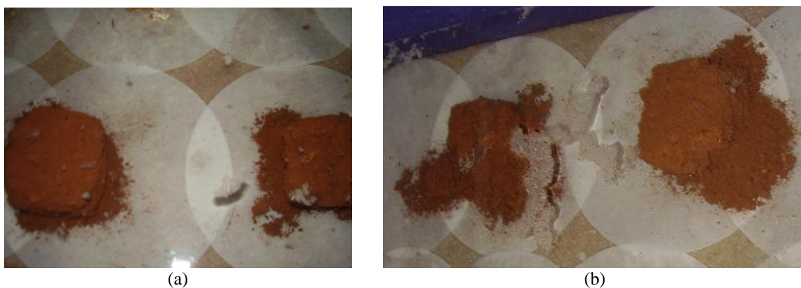
Figura 5.19 - Ensaio de desagregação do solo laterítico da voçoroca Contorno (a) Inundação imediata; (b) Inundação parcial.
