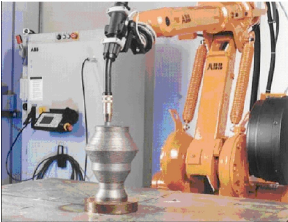
Figura 1.1 – Figura meramente ilustrativa da simulação de um processo de Soldagem 3D utilizando GMAW. [2]
