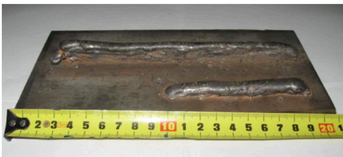
Figura 3.4 – Amostra a ser estudada, fabricada pelo método da prototipagem rápida por soldagem a arco (amostra superior).
