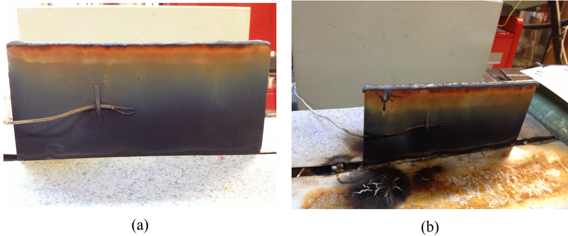
Figura 7.6 – Efeito do arco da tocha no aumento da temperatura superficial das faces laterais e sua influência na fuligem. Queima do material isolante pelo arco em (b). Corrente do ensaio (b) maior que do ensaio (a).
