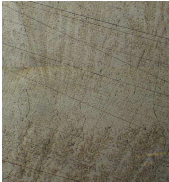
Figura 3.17 – Zona de fusão de cordões adjacentes no metal de solda.
