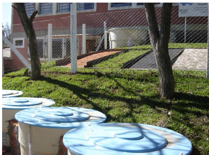
Figura 3.9 – Parcelas e caixas coletoras para simulação do escoamento superficial da água em diferentes pavimentações (Maus et al. , 2007)
