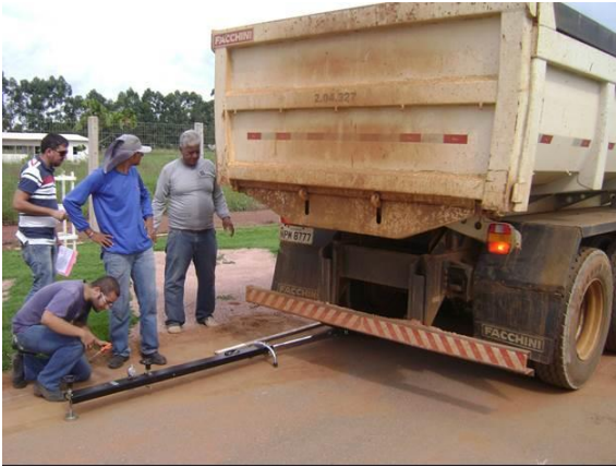
Figura 5.30 - Vista do procedimento inicial do ensaio com a viga Benkelman.
