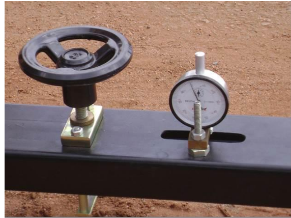
Figura 5.31 - Detalhe do extensômetro instalado sobre a viga Benkelman.
