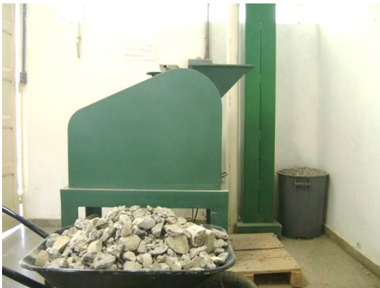
Figura 3.7 - Vista geral do britador de mandíbulas com restos de concretos.
