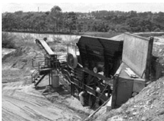
Figura 2.14 - Britador de mandíbulas utilizado para a produção dos agregados reciclados.
