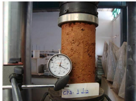
Figura 3.14 - Detalhe do ensaio de resistência à compressão simples (com 1 dia de cura).
