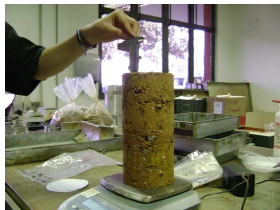
Figura 3.16 - Detalhe da medição da altura do corpo-de-prova.
