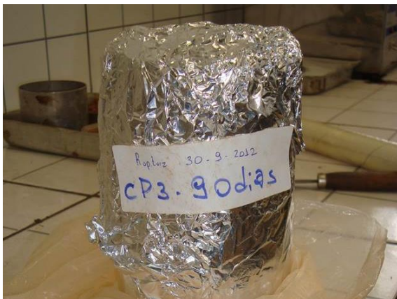
Figura 3.13 - Corpo de prova da mistura de solo-RCD com ruptura para 90 dias.
