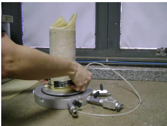
Figura 3.17 - Colocação da membrana sobre a amostra de solo-RCD.
