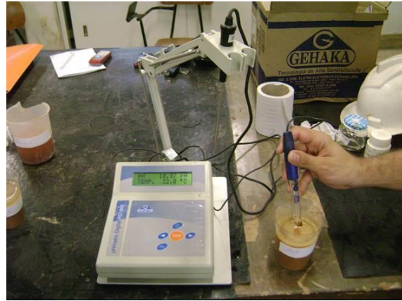
Figura 3.10 - Detalhe da medição pH em uma das misturas de solo-RCD.
