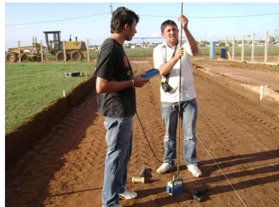
Figura 5.27 - Retirada das hastas ao término do ensaio com o penetrômetro PANDA.
