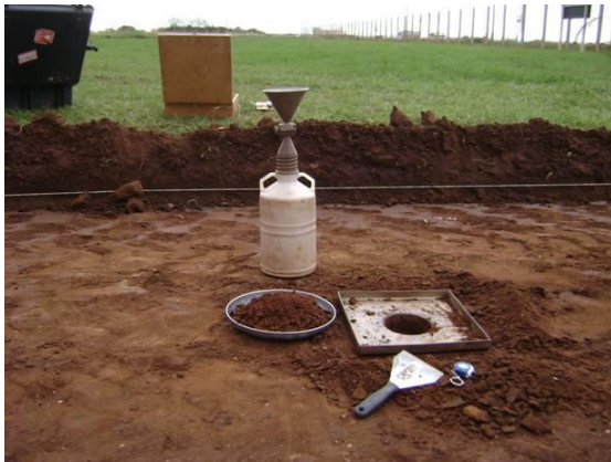
Figura 5.22 - Conjunto para determinação da massa específica aparente “ in situ ”.
