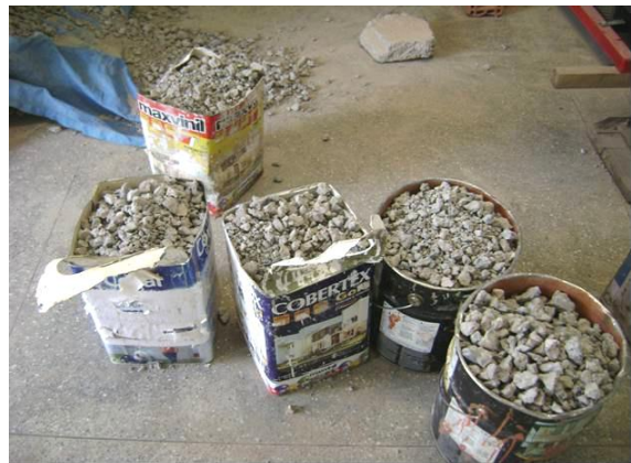
Figura 3.8 - Detalhe dos resíduos de concreto fracionados.
