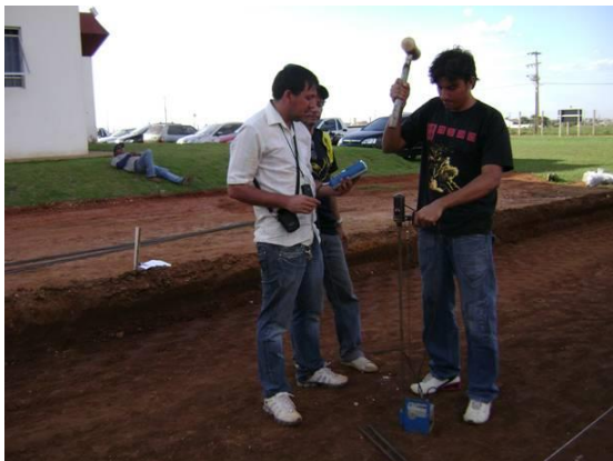
Figura 5.26 - Aplicação da energia sobre a haste e leitura das medidas da resistência q_d .
