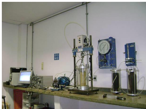
Figura 3.18 - Detalhe do andamento do ensaio do módulo de resiliência.
