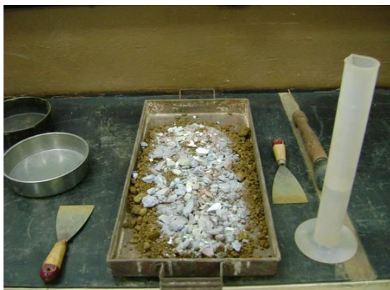
Figura 3.15 - Preparação da mistura de solo-RCD para confecção do corpo-de-prova.
