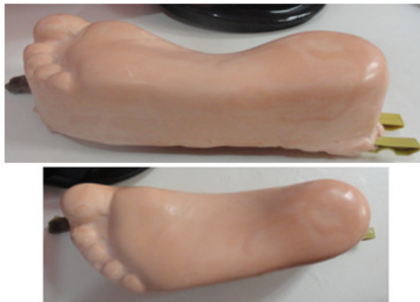
Figura B.1. Molde do pé (região plantar) para confecção da palmilha sensorizada.
