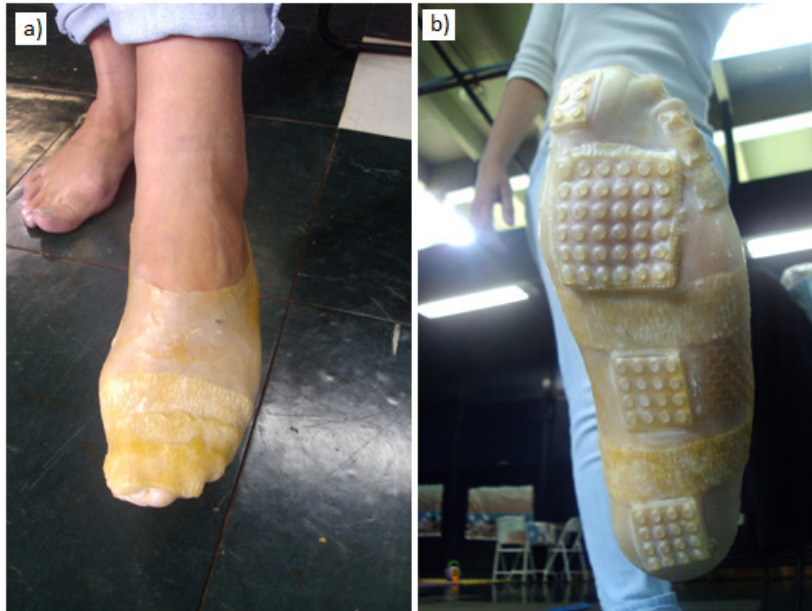
Figura B.8 – Protótipo da palmilha amortecedora: a) parte frontal da palmilha; b) destaque para os amortecedores.
