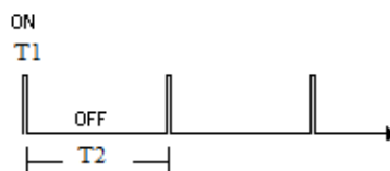
Figura E.1 - Representação de T1 e T2. Configuração astável e com ciclo de trabalho menos de 50%.
