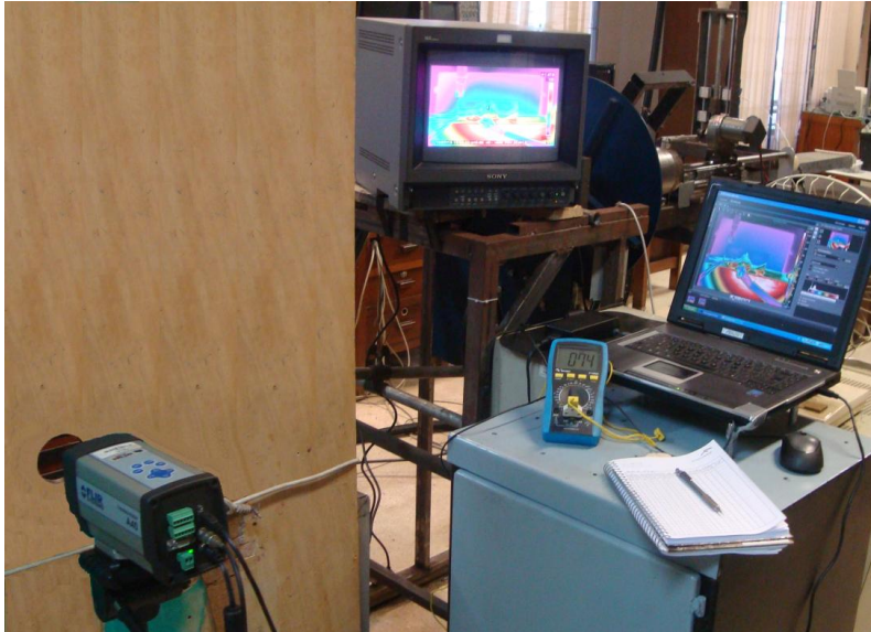
Figura 51: Equipamentos utilizados para o monitoramento termográfico da soldagem.
