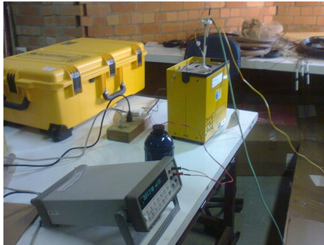
Figura 44: Equipamentos utilizados para calibração do termopar.
