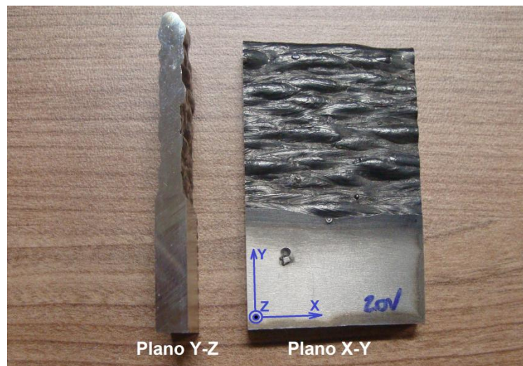
Figura 52: Escolha das seções a serem analisadas e corte das amostras.
