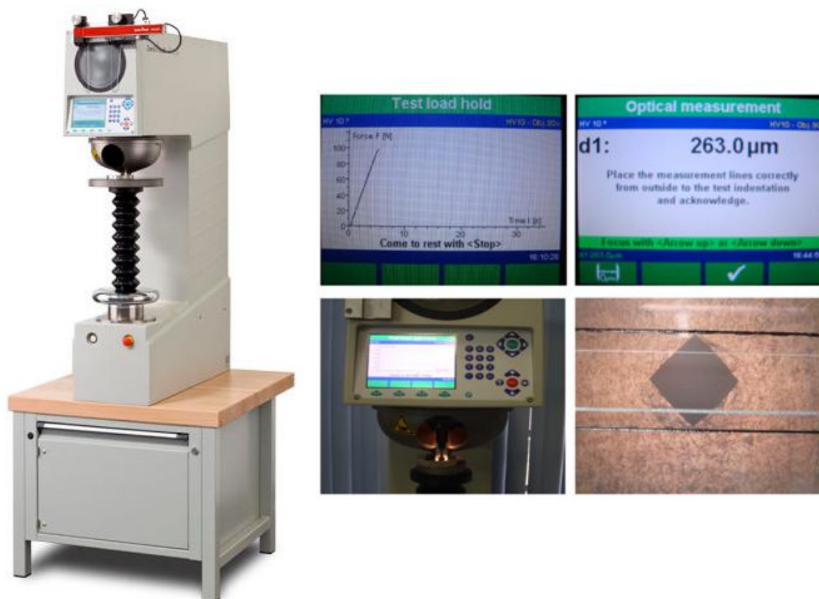
Figura 57: Realização do ensaio de dureza Vickers (HV10).
