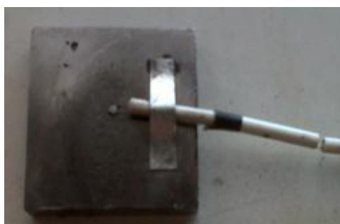
Figura 36: Termopar tipo K soldado na amostra a ser ensaiada.
