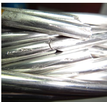
Figura 33 – Detalhe da amostra com falha na camada interna.
