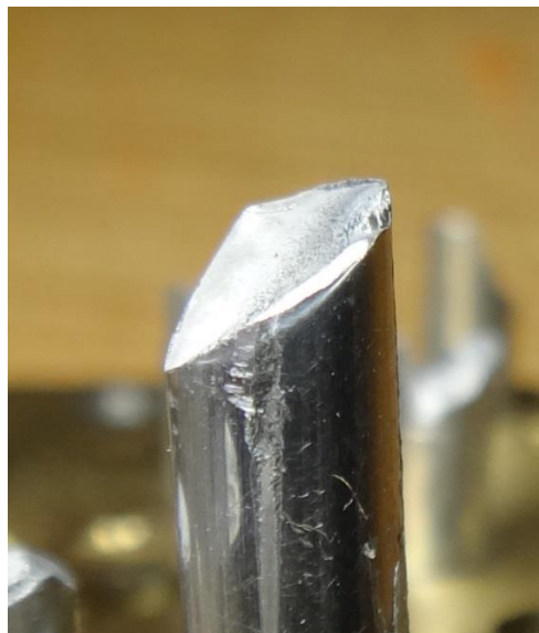
Figura 54 – Tipologia da falha localizada na base do condutor.
