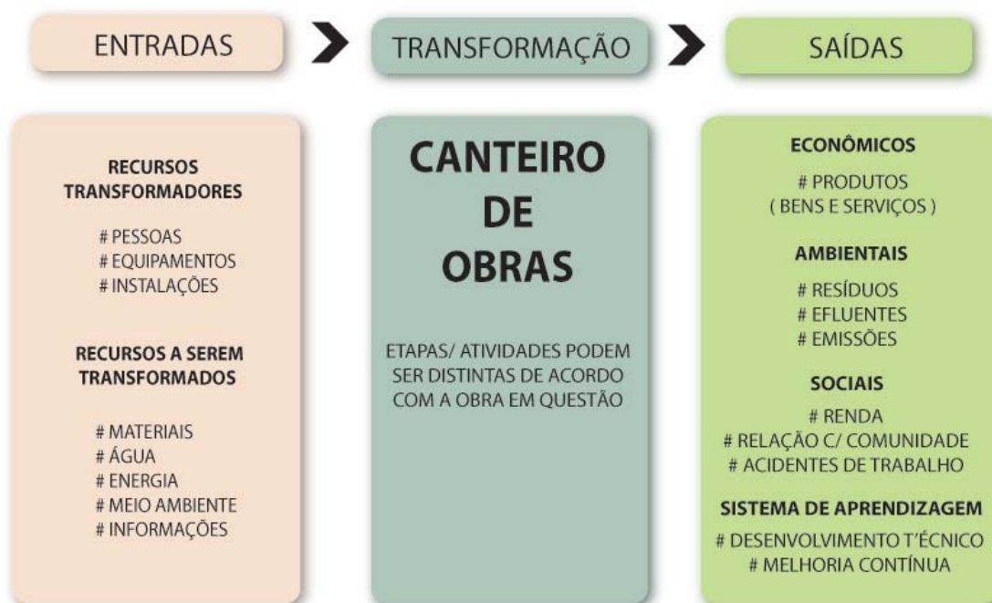
Figura 6- Modelo de transformação nos canteiros de Obras.
