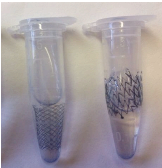
Figura 13. Configuração do fragmento de stent no interior do tubo de Eppendorf®. À esquerda o stent de Cobalto-Cromo (WallStent®) e à direita o stent de Nitinol (Protégé®) (arquivo pessoal)
