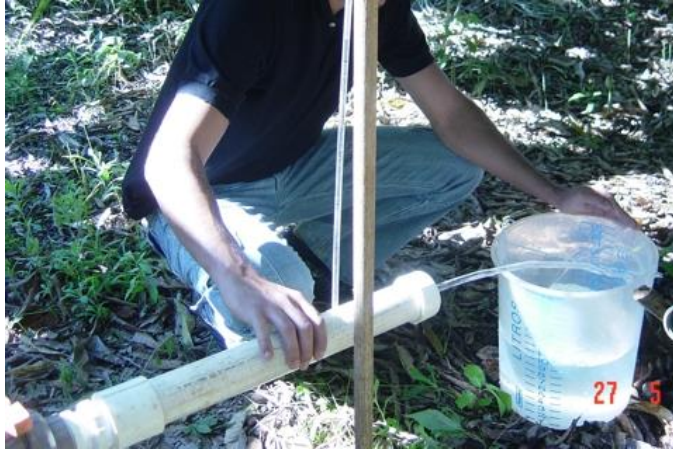
Figura 4. 6 – Medição direta da vazão de bombeamento
