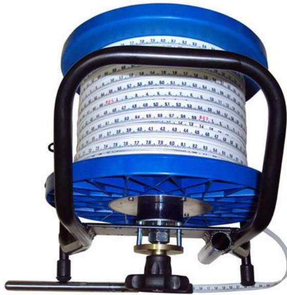
Figura 4. 3 - Medidor de nível freático
