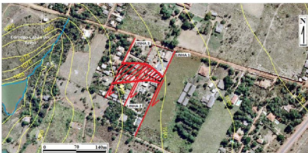
Figura 4.14 - Delimitação da pluma de contaminação pelo levantamento geofísico
