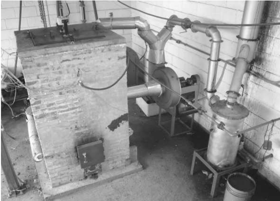
Figura 2.6: Forno para a Torrefação de biomassa no GCA (IFGW/UNICAMP)
