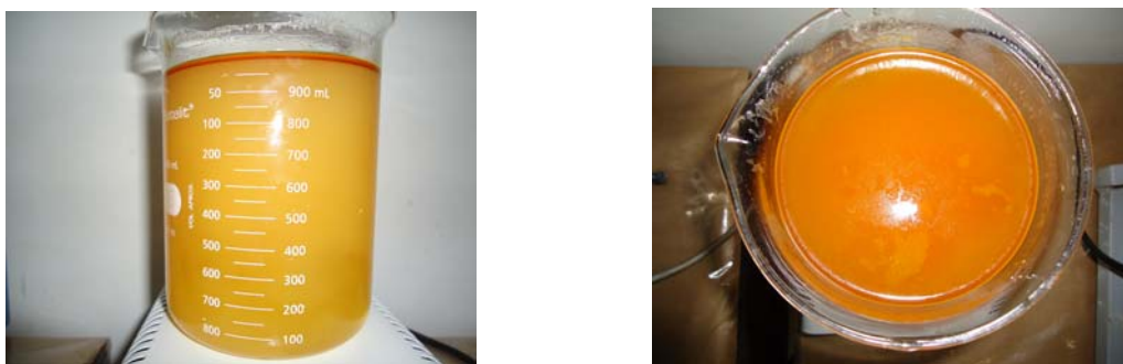
Figura 5.3 – Camada de óleo formada após a desemulsificação da água residuária de biodiesel com H_2SO_4 .
