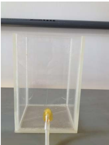
Figura 4.3 – Jarro com capacidade de um litro usado nos ensaios de coagulação/floculação. Vista frontal (a) e superior (b).
