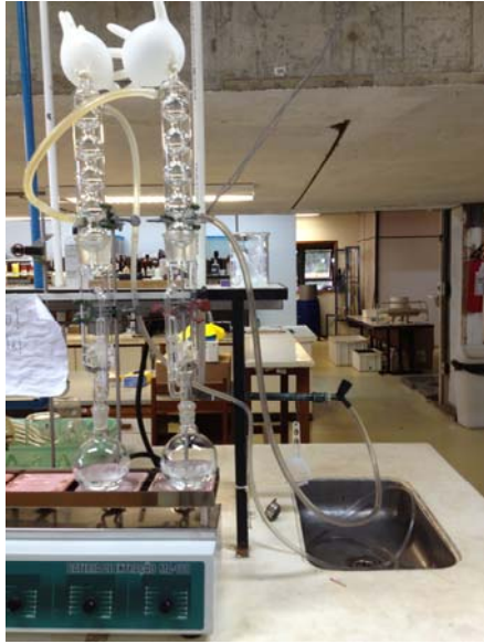
Figura 4.4 - Sistema de extração de Soxhlet utilizado na extração de óleos e graxas.
