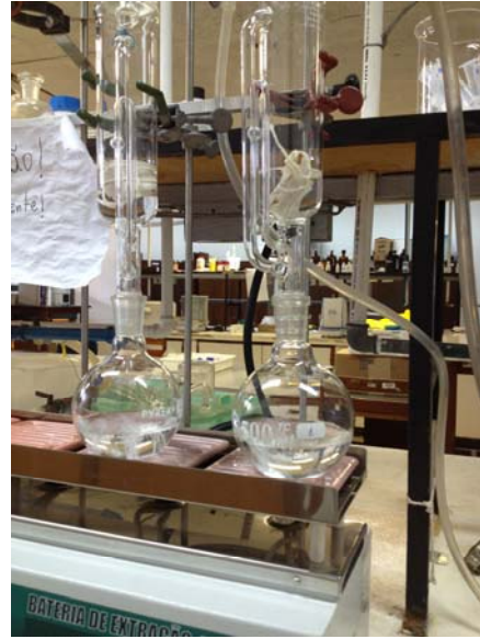
Figura 4.4 - Sistema de extração de Soxhlet utilizado na extração de óleos e graxas.
