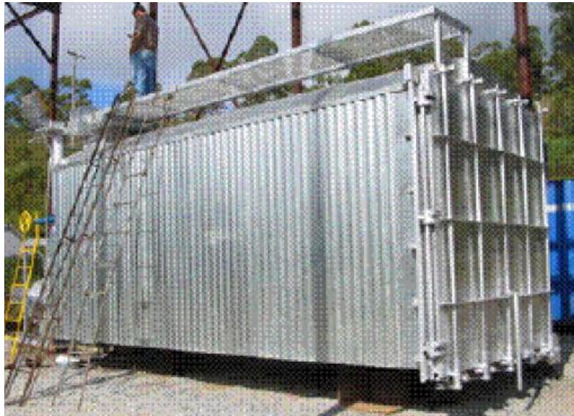
Figura 12 - Exemplo de forno metálico. Fonte: (Pinheiro, 2009)
