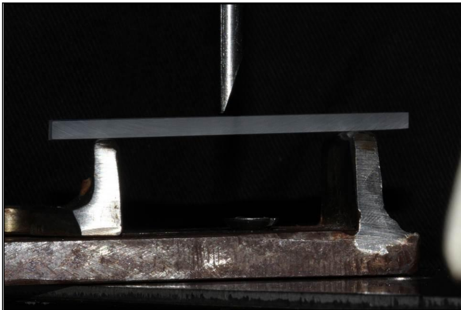
Figura 2 – Corpo de prova em máquina de ensaio universal EMIC modelo DL 3000, para início de teste de flexão
