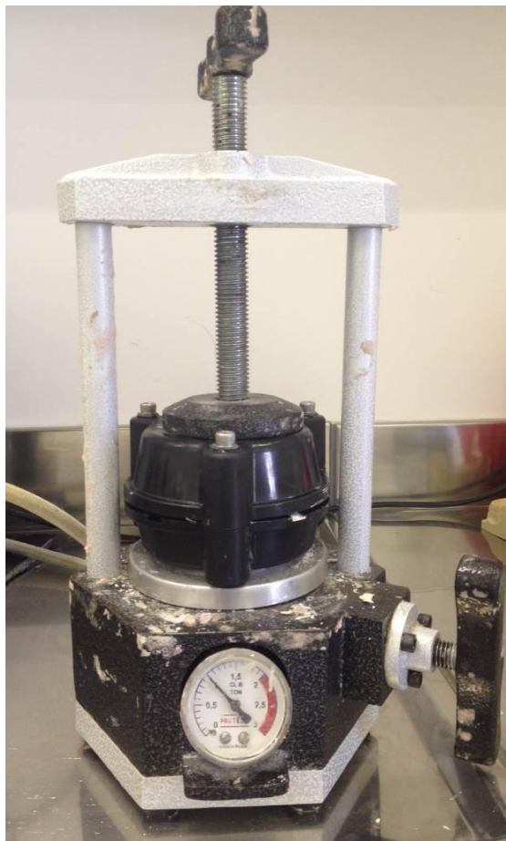
Figura 4 - Matriz plástica sendo prensada a 1000kgF.
