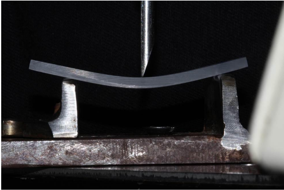
Figura 11 – Corpo de prova durante teste de flexão.
