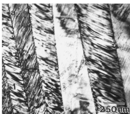
Figura 2.14 - Estrutura martensítica de uma liga de NiTiZr. Fonte: HSIEH (1997).
