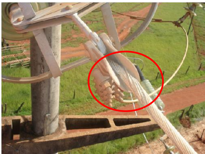
Figura 2.1 – Representação, em destaque, da falha por fadiga por fretting de um cabo de transmissão elétrica
