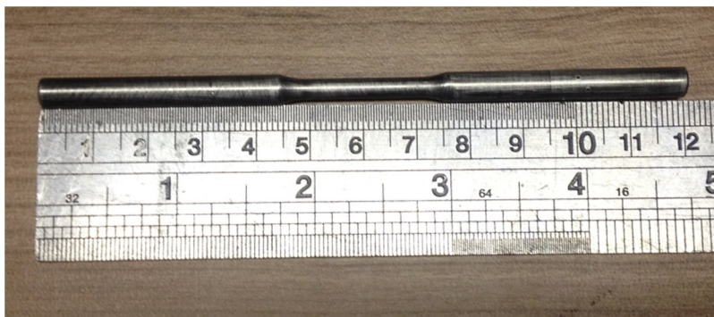
Figura 3.2 - Cp de tração NiTi, escala em mm.
