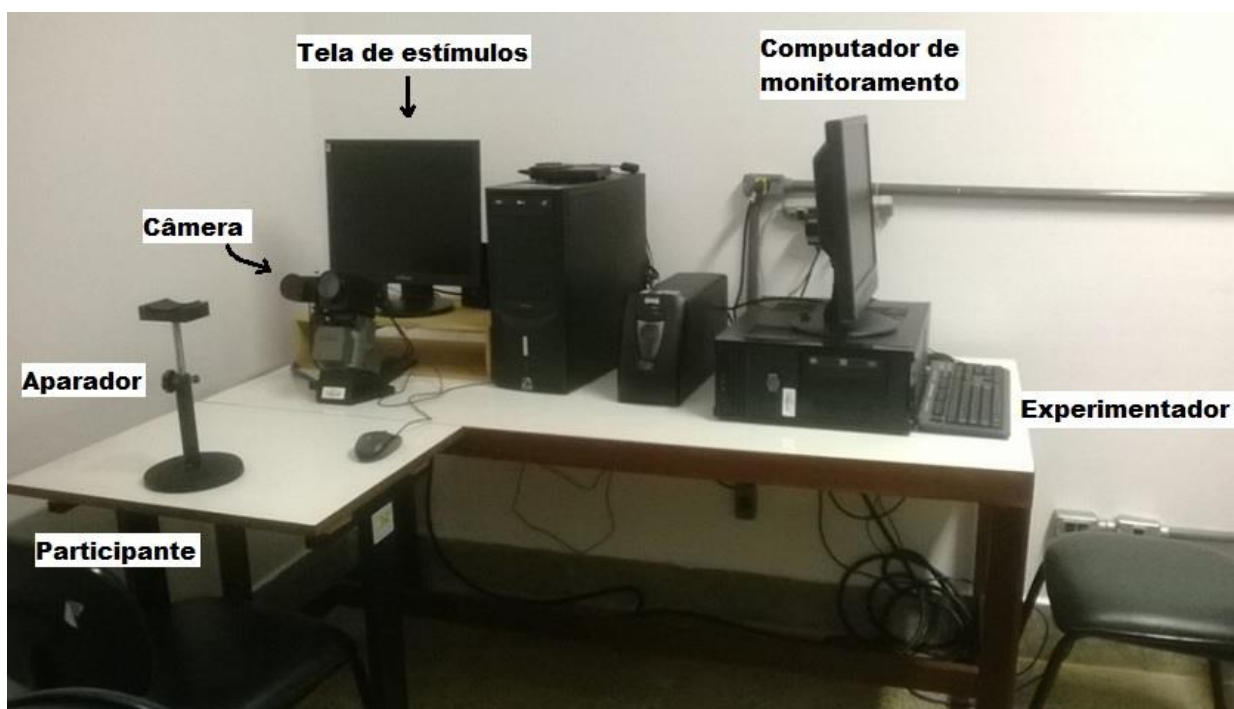
Figura 1. Arranjo experimental. O pesquisador se posicionou no computador a direita da foto, enquanto o participante se sentava em frente ao computador da esquerda, colocando o queixo no aparador, observando a tela de estímulos e utilizando o mouse próximo ao aparador. A câmera posicionada entre o participante e a tela de estímulos captava os pontos de fixação do olhar e enviava as informações para o computador de monitoramento.
