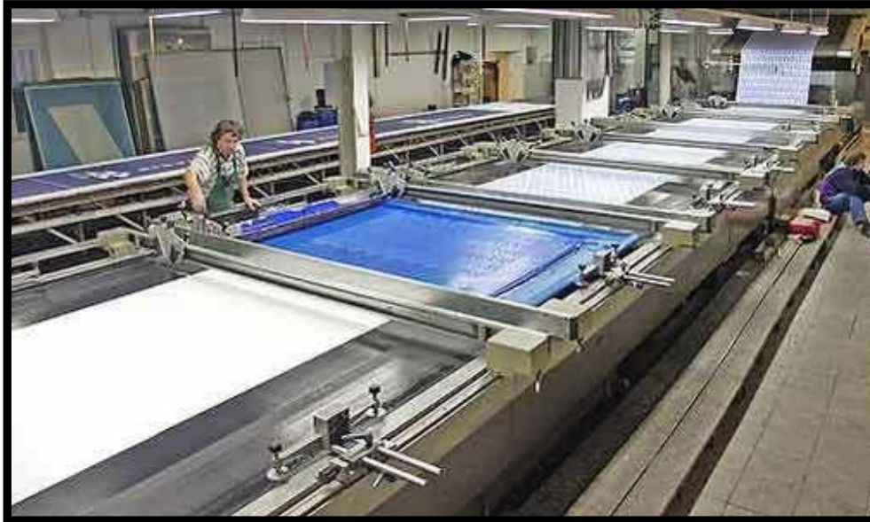
Figura 16. Estrutura de impressão quadro à quadro. (Second Hand Automatic Textile Flat Bed Printing) Disponível em: < http://www.security-exp.net/b2b/surveillance_equipments/1/secondhand_automatic_textile_44.html > Acesso em 20/09/2013.
