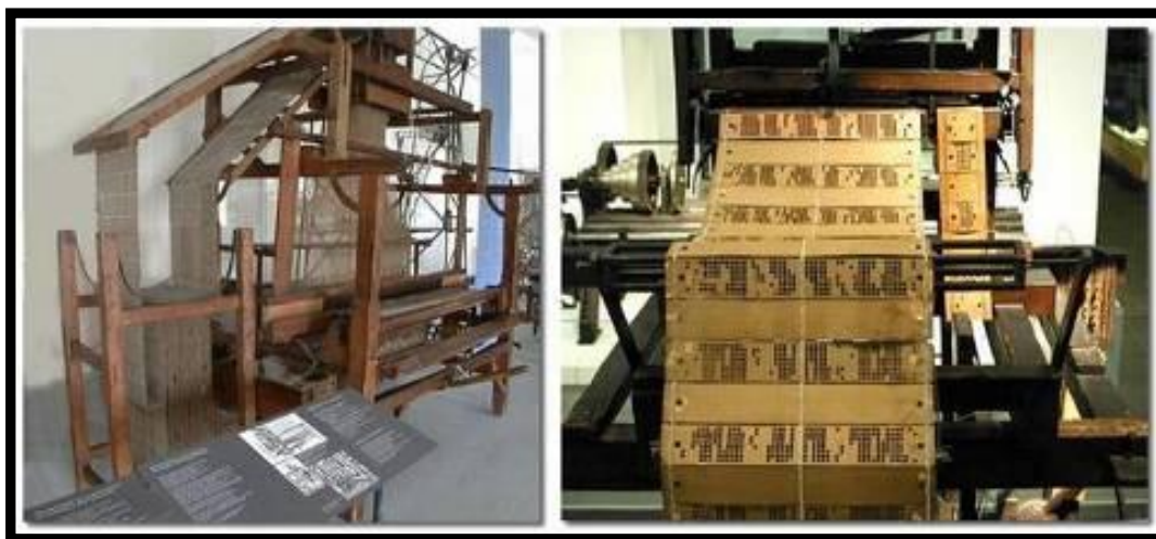
Figura 37. Tear de Jacquard antigo. Utilizando cartões perfurados, os desenhos sempre foram complexos e com uma infinidade de cores. Disponível em: < http://www.vam.ac.uk/content/videos/j/video-jacquard-weaving/ >. Acesso em 24/02/2012.
