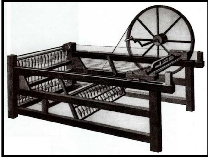
Figura 6. “Spinning Jenny” – máquina de fiar com alta produtividade, criada por James Hargreaves em 1764. Fonte: < http://histoblogsu.blogspot.com.br/2009_06_01_archive.htm >. Acesso em 29/08/2012.
