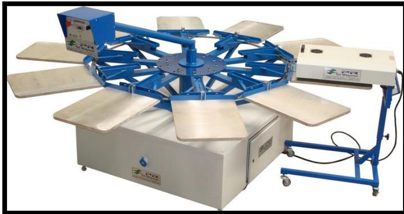
Figura 18. Carrossel mecânico com giro automático. Utilizado para impressão de grande quantidade de camisetas.
