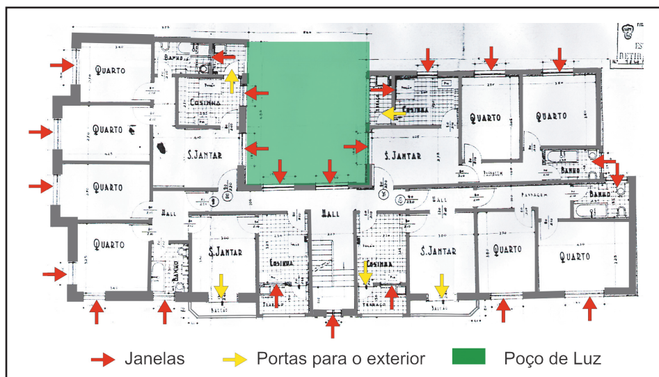
Figura 6.95 Planta de edificação. Ventilação. Fonte: O autor
