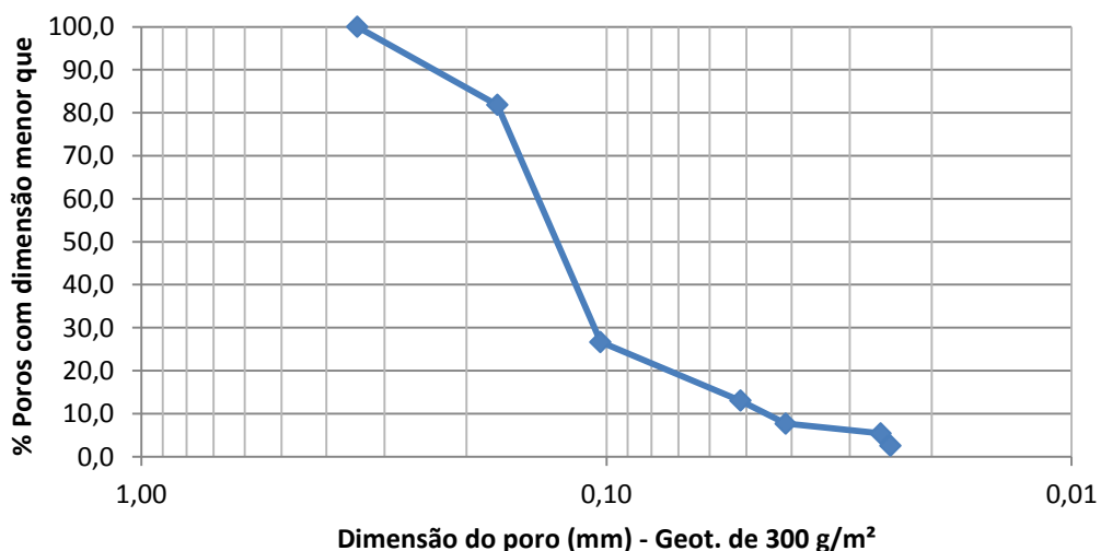
Figura 4.56 - Curva de distribuição de abertura dos poros do geotêxtil de 300 g/m 2 - ensaio realizado com equipamento montado na Universidade de Brasília.
