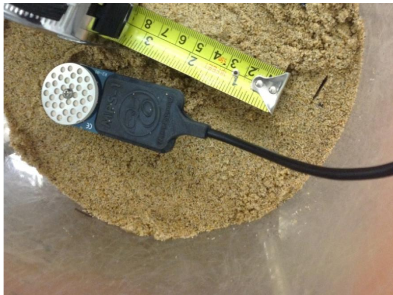
Figura 3.10 - Detalhe do sensor MPS-1 colocado sobre a superfície de uma camada de areia dentro do cilindro de execução da coluna.
