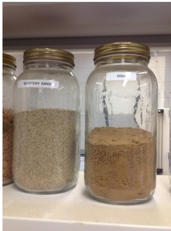
Figura 3.1 - Amostras de areia Monterey nº30 e de solo RMA Tipo 2 em recipientes de vidro no laboratório de Geotecnia da UT-Austin.
