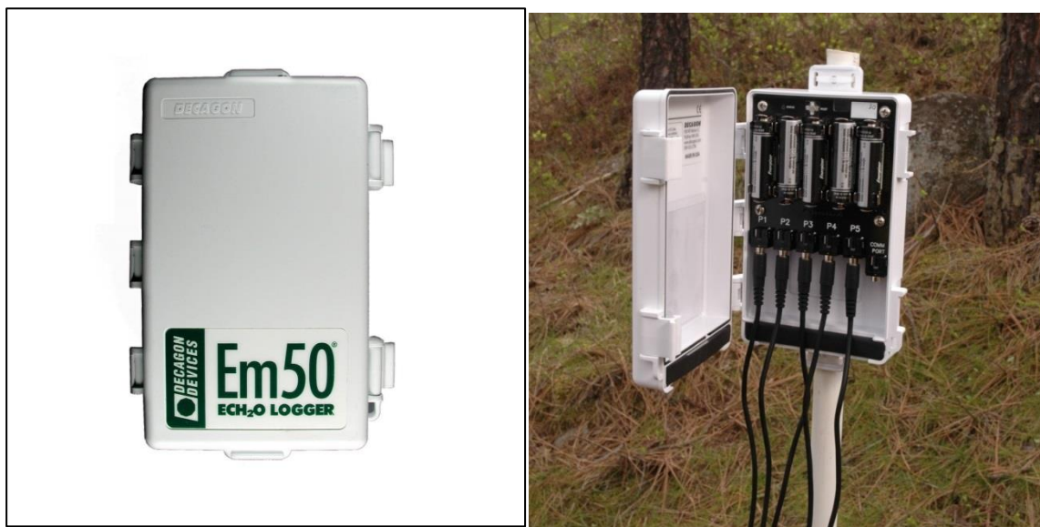
Figura 3.8- Recipiente de proteção do datalogger e detalhe do equipamento aberto com as conexões para os sensores (Fonte: www.decagon.com )
