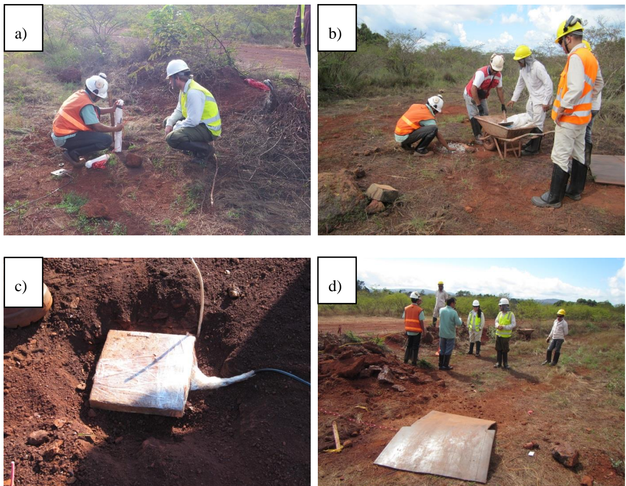
Figura 4.5 Montagem dos pontos de tiro e do sensor de gatilho. a) Colocação do explosivo no furo. b) Tamponamento do furo com brita. c) Posicionamento do sensor de gatilho preso a uma placa de alumínio sobre o ponto de tiro. d) Colocação de cobertura de borracha para evitar lançamento de detritos pela explosão.
