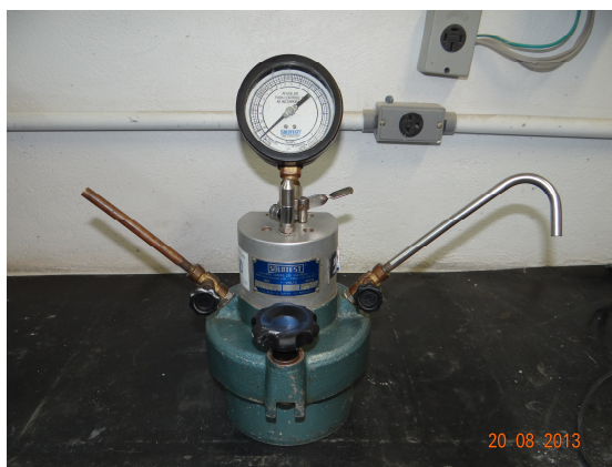
Figura 2.2- Equipamento para realização do ensaio de ar incorporado.
