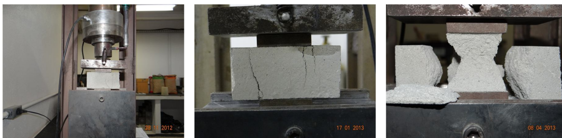
Figura 3.15- Procedimento do ensaio de resistência à compressão axial: (a) detalhe do meio-prisma colocado na prensa (b) meio-prisma rompido (c) detalhe do meio-prisma rompido
