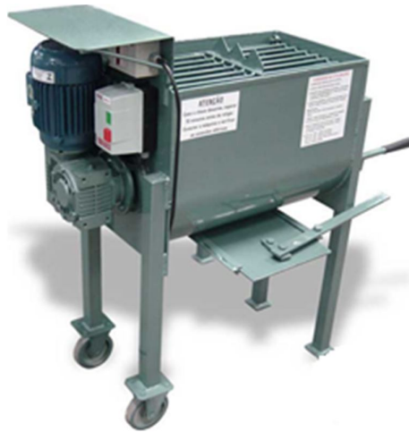
Figura 3.10- Misturador de argamassa utilizado nos ensaios
