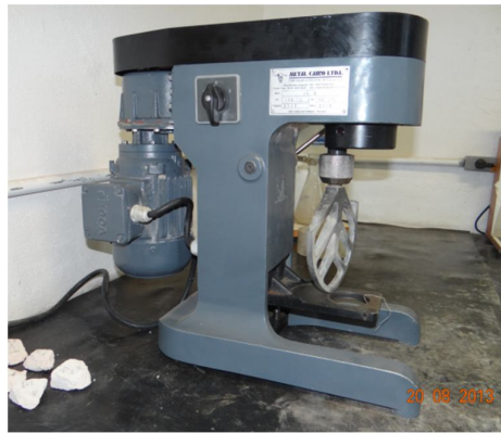
Figura 3.9- Misturador mecânico utilizado nos ensaios
