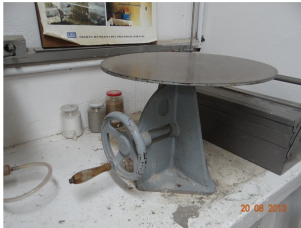
Figura 2.6- Equipamento utilizado no ensaio para determinação do índice de consistência
