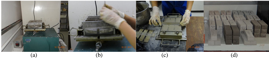
Figura 3.12- Procedimento do ensaio de prismas em argamassa: (a) detalhe da forma no adensador mecânico (b) detalhe da moldagem da 1ª camada (c) detalhe da retirada do excesso argamassa (d) detalhe dos prismas acondicionados em ambiente controlado
