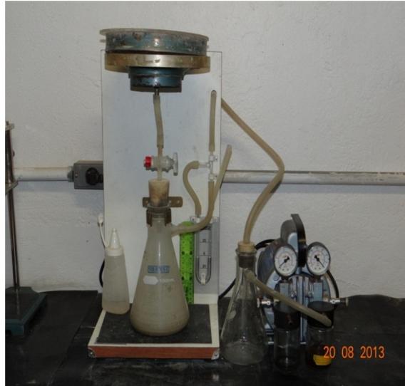
Figura 2.1- Funil de Buchner modificado utilizado para ensaio de retenção de água
