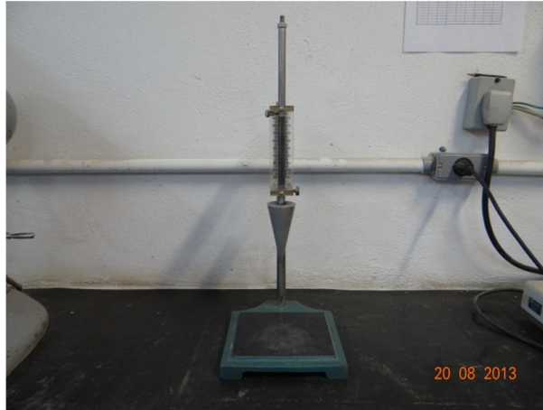
Figura 2.7- equipamento utilizado para ensaio de penetração estática de cone
