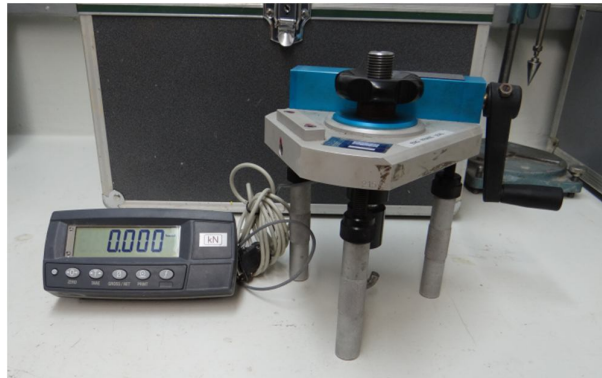
Figura 2.5- Equipamento utilizado para ensaio de aderência à tração
