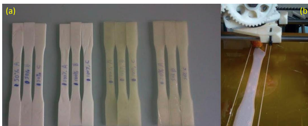
Figura 15: Alguns dos Corpos de prova impressos em Impressora 3D RepRap. (a): seis da esquerda são importados e os seis da direita nacionais, foto (b): detalhe da impressão do corpo de prova. (Fonte: Autor)
