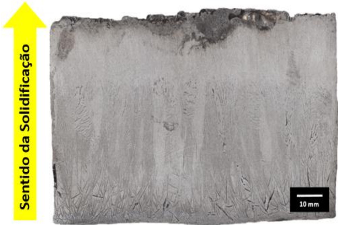
Figura 4.7: Macroestruturas da seção longitudinal da liga Al-8,5%Ni.
