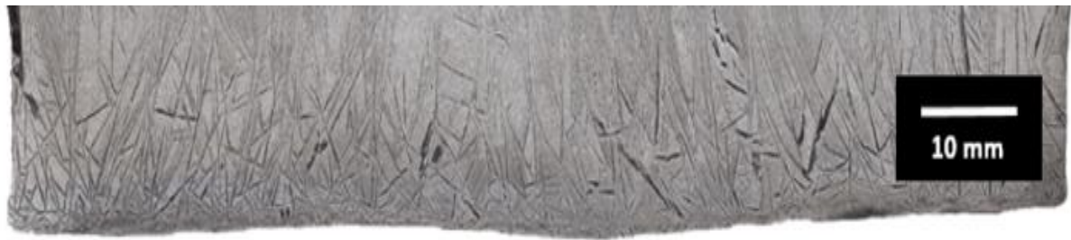
Figura 4.10: Detalhe da fase primária Al_3Ni desenvolvida de forma aleatória em região próxima e retirada de calor na liga Al-9%Ni.
