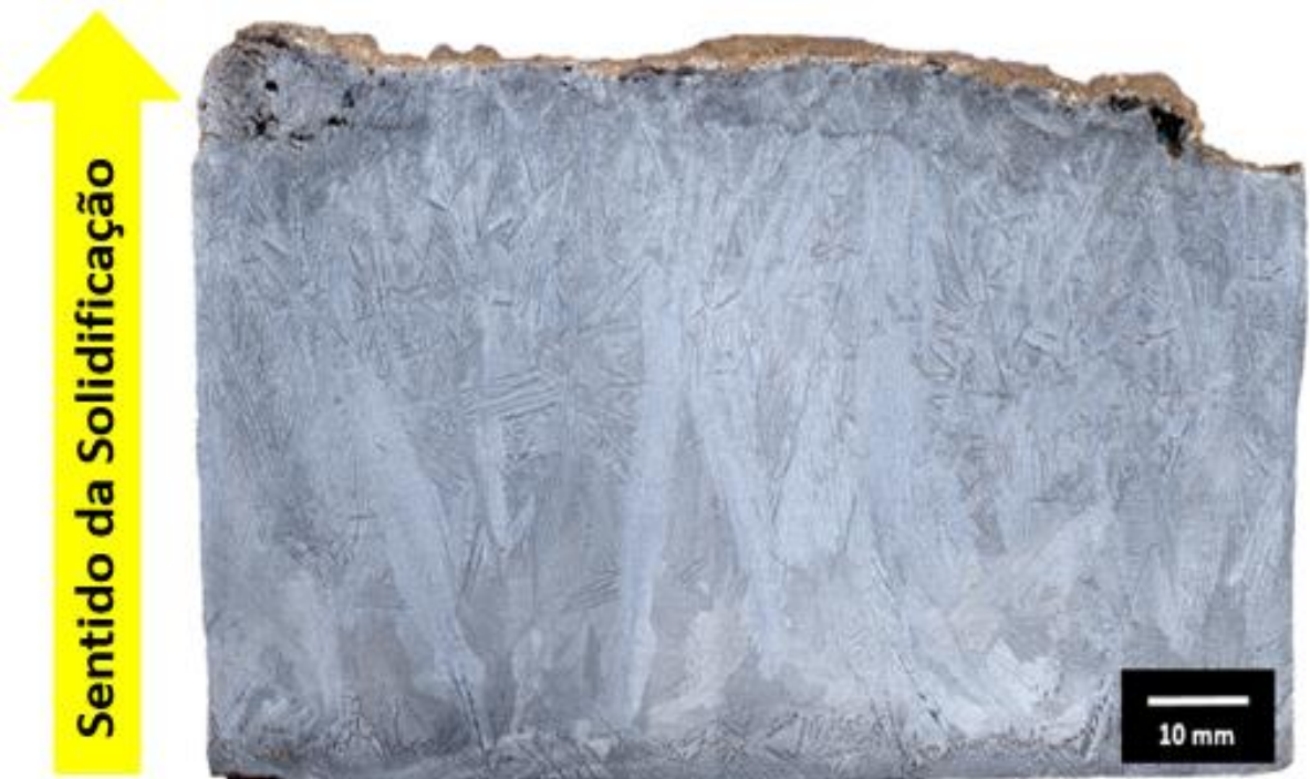
Figura 4.8: Macroestrututra da seção longitudinal da Liga Al-9%Ni.
