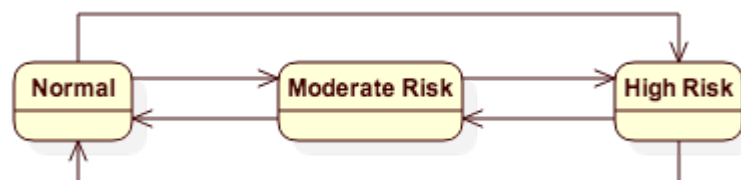
Figura 4.7: Exemplo de diagrama de máquina de estados da UML
