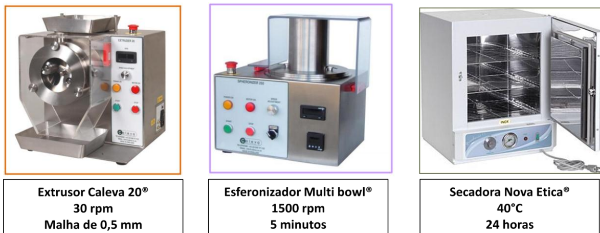
Figura 5: Equipamentos de pelletização por extrusão esferonização. Extrusor de rolos (à esquerda), Esferonizador (ao centro) e Secadora/Estufa (à direita).
