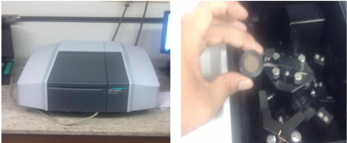
Figura 20: Foto do espectrômetro UV-Vis usado para a caracterização óptica. b) O porta-amostras contendo Sn 1-x Cr x O 2 .
