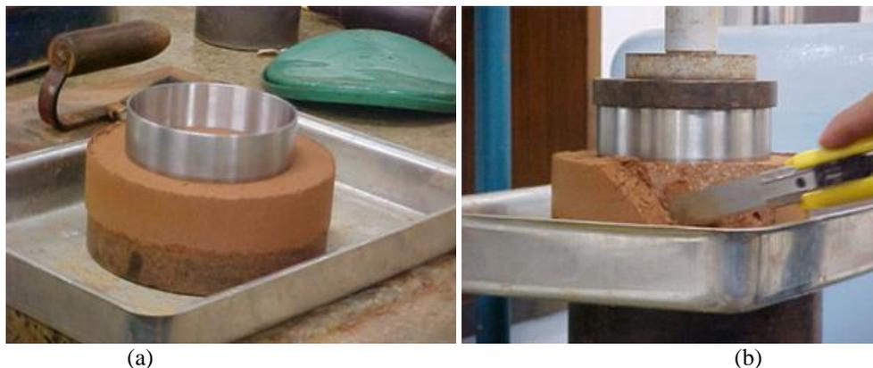
Figura 3.17 Moldagem do corpo de prova: a) Anel de adensamento e corpo de prova compactado, b) Cravação do anel no corpo de prova.
