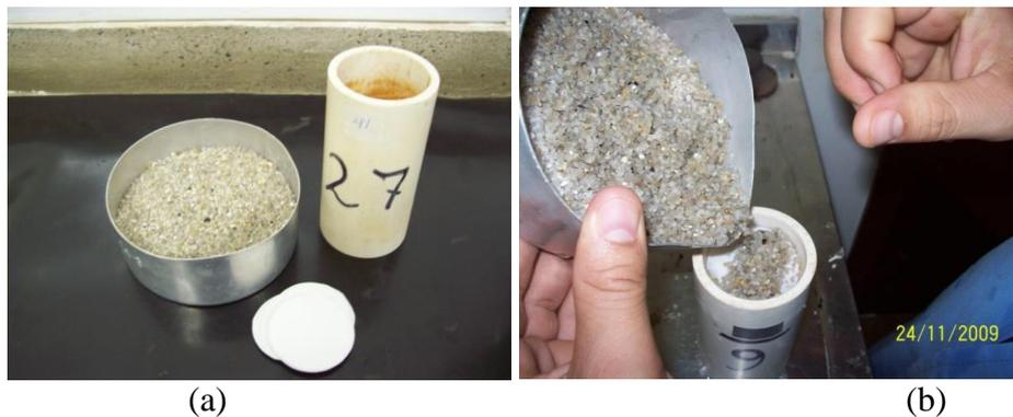
Figura 3.10 (a) Materiais Utilizados; (b) Colocação da areia padrão com a finalidade de distribuir o fluxo.
