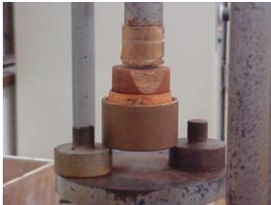
Figura 3.15 Desmoldagem dos corpos de prova do cilindro de PVC.
