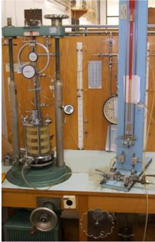
Figura 3.22 Painel utilizado para a realização do ensaio triaxial a diferentes trajetórias.
