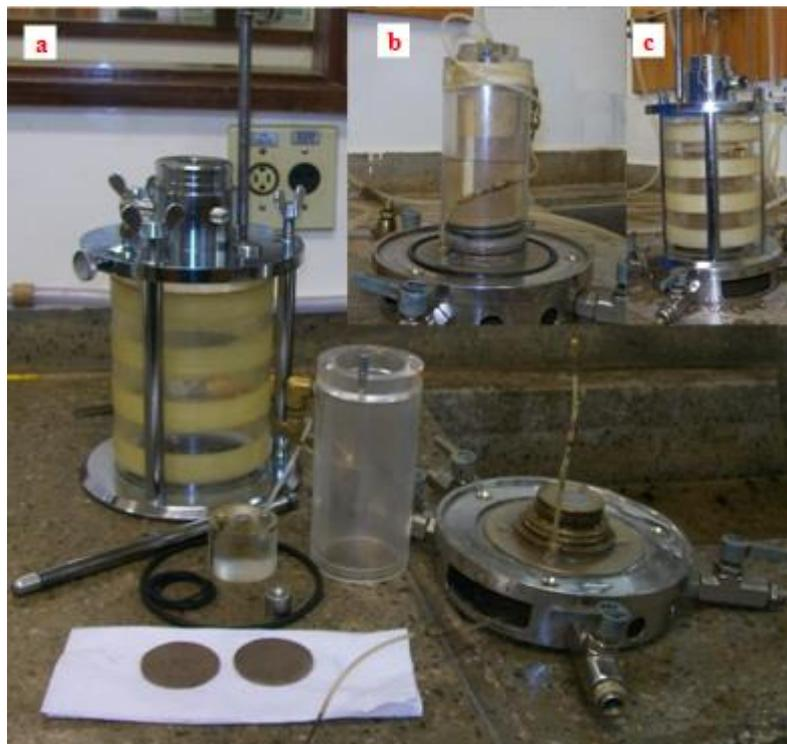
Figura 3.20 Célula triaxial tipo  $k_0$ : a) Partes da célula desmontada, b) Célula interna montada, c) Célula completamente montada.
