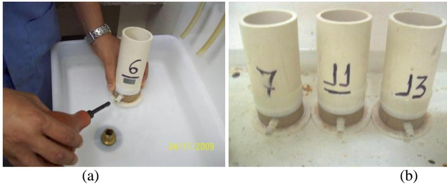
Figura 3.12 (a) Colocação da água nas amostras; (b) Amostras imersas em água destilada.
