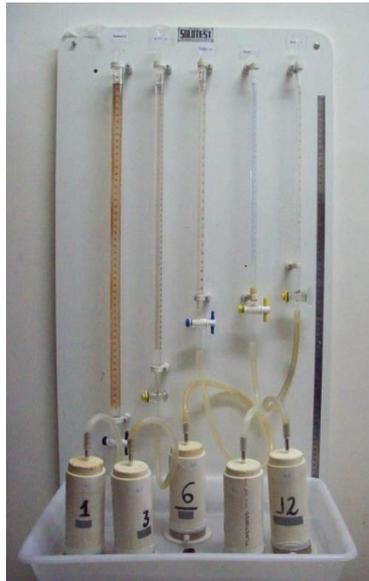
Figura 3.14 Ensaio de Permeabilidade com permeômetro de parede rígida.
