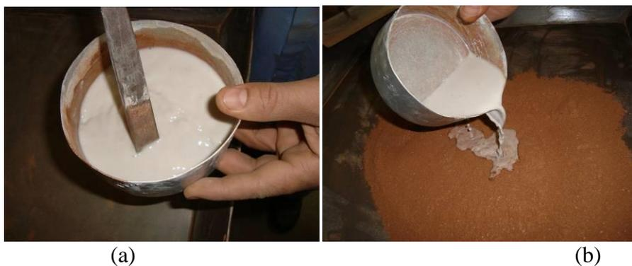
Figura 3.6 Método de mistura solo-cal: a) Mistura da cal na água; b) Adição da mistura ao solo.
