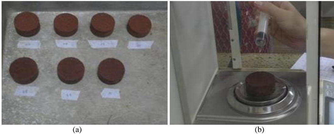
Figura 3.16 Preparação dos corpos de prova para ensaio de papel filtro: a) Secagem ao ar, b) Umedecimento por gotejamento.
