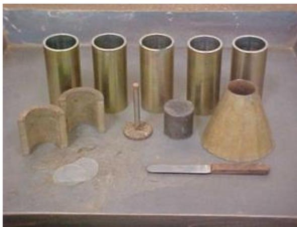
Figura 3.5 Equipamento Utilizado no Ensaio de Mini-MCV.
