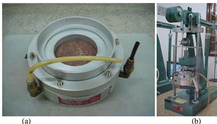
Figura 3.18 Montagem do Ensaio: a) corpo de prova dentro do anel, b) Prensa de adensamento
