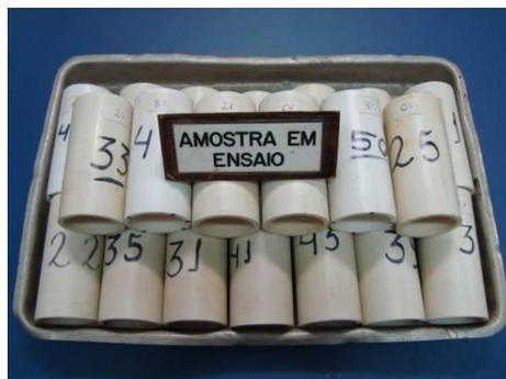
Figura 3.8 Amostra Compactadas em Processo de Cura ao Ar.
