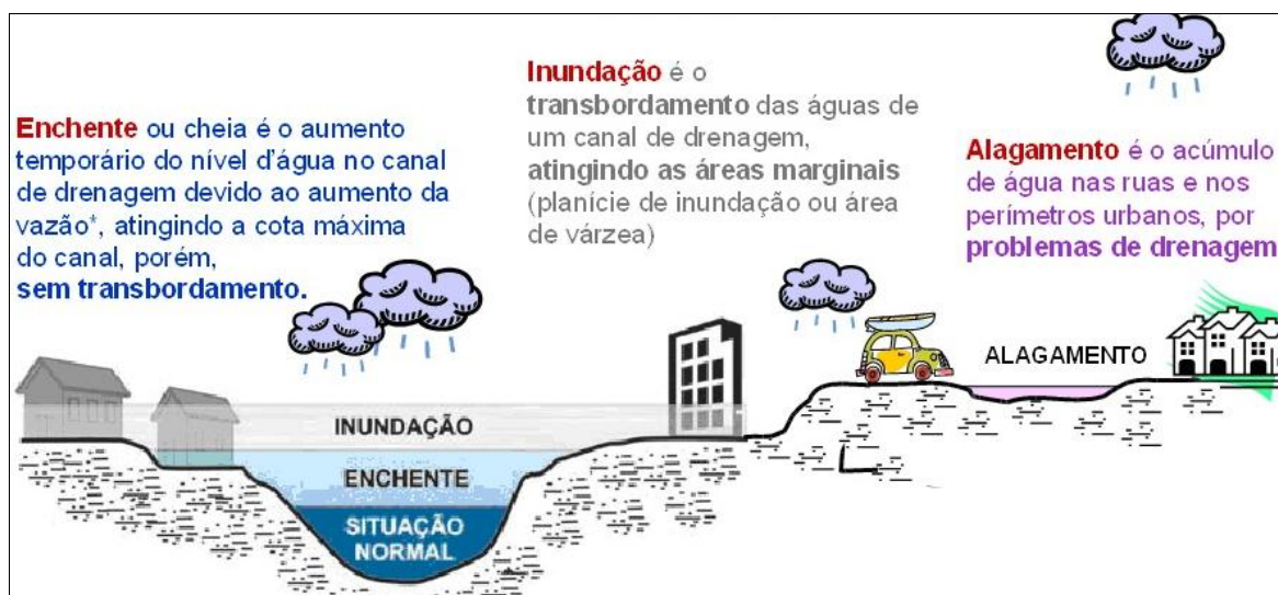
Figura 2.2 – Esquema para distinguir tipos de escoamento e acúmulo superficial de água (Fonte: http://dcsbcsp.blogspot.com.br e modificado de Carvalho et al., 2007).
