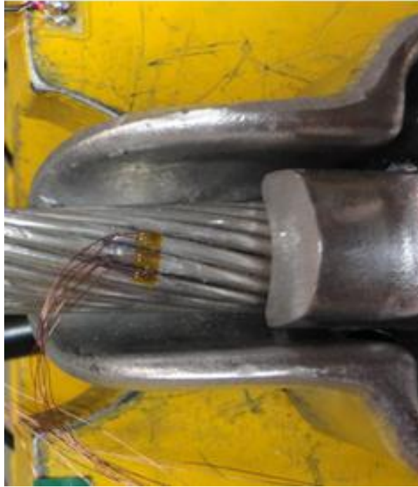
Figura 7.8 – Extensômetros com camada de resina protetora e soldados.
