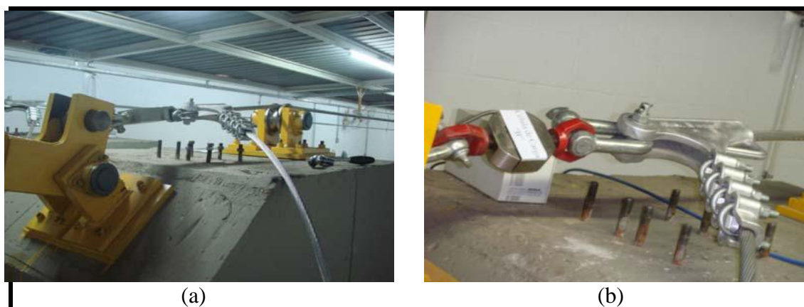
Figura 0.3 – a) Fixação do cabo através do grampo de ancoragem passante no bloco fixo 3, b) Detalhe do grampo de ancoragem passante e a célula de carga [8].
