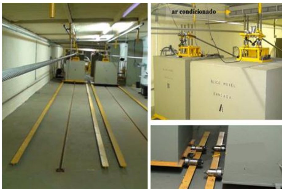
Figura 0.4 – Grampo de ancoragem montado em uma base de concreto com rolamentos e os trilhos [8].
