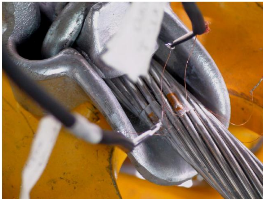
Figura 7.7 – Extensômetros no cabo sob a fita adesiva e soldados trocar foto.
