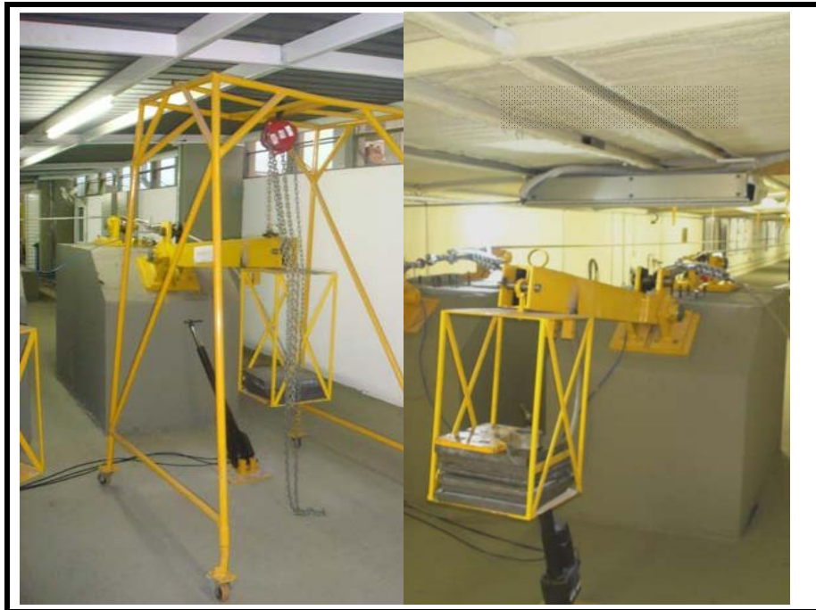
Figura 0.6 – Bloco fixo 3 que contém os dispositivos para controle de tração do cabo [8].
