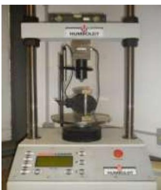
Figura 3.9 Ensaio de Resistência à tração.
