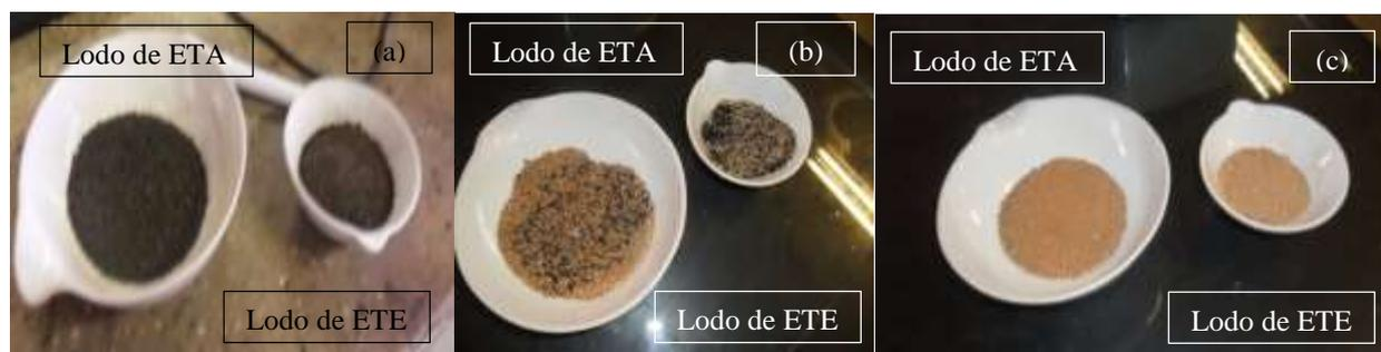
Figura 4.2 Variação dos lodos de ETA e de ETE após da calcinação: (a) Calcinação a 300 ° C; (b) Calcinação a 500 ° C; (c) Calcinação a 800 ° C.
