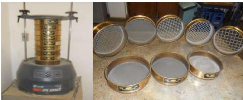
Figura 3.3 Equipamento de granulometria: (a) Peneirador mecânico; (b) Peneiras serie ASTM.
