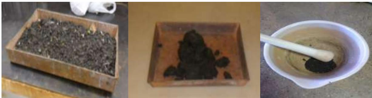
Figura 3.1 (a) Amostra de lodos de ETE na condição seca; (b) Amostra de lodos de ETA na condição úmida; (c) Destorramento dos lodos de ETE.
