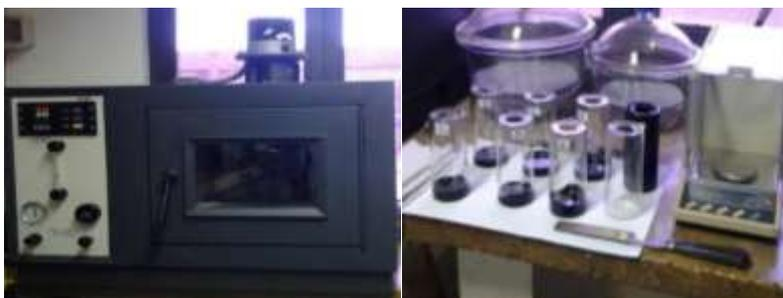
Figura 3.6 Equipamento do Ensaio RTFOT.
