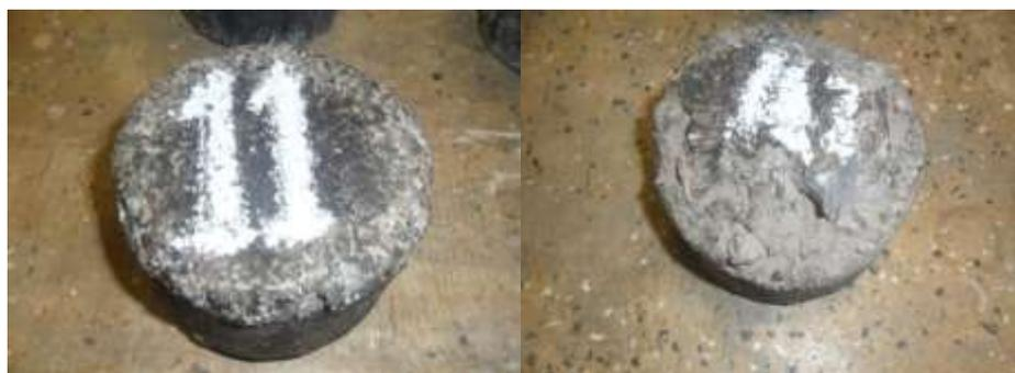
Figura 4.29 Corpos de prova após o ensaio Cântabro: (a) Mistura 1 - Asfalto convencional; (b) Mistura 4 - Asfalto modificado com lodos de ETE.
