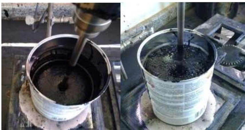
Figura 4.10 Mistura de CAP e lodo de ETA seco ao ar.
