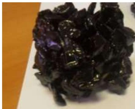
Figura 3.4 Ensaio de adesividade ao ligante asfáltico.
