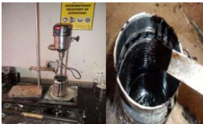
Figura 3.5 (a): Equipamento rotacional para elaboração de misturas; (b) Sedimentação, 30% Lodo de ETA e 70% CAP 50/70.
