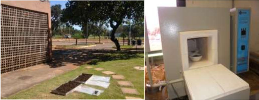
Figura 3.2 (a) Secagem ao ar dos lodos ETA; (b) Forno mufla.
