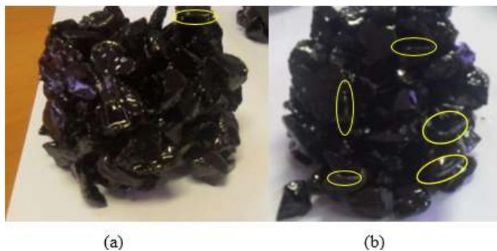
Figura 4.3 Adesividade com os Ligantes de referência: (a) CAP 50/70; (b) 80% CAP + 20% CAL.
