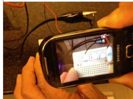
Testes do funcionamento dos IR LEDs para construção do eye tracking conduzidos pelo engenheiro Yamaguti (2012).
