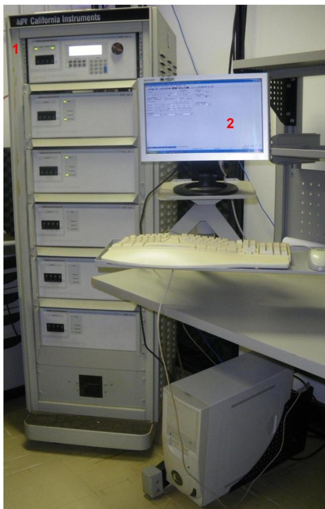
Figura 3.3 – Fonte trifásica programável e microcomputador de controle.
