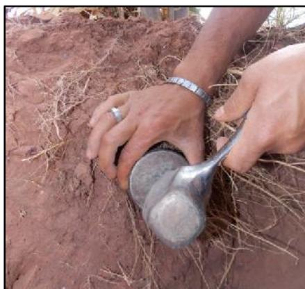
Figura 5 - Representação de coleta de amostra de solo indeformada (anel volumétrico sendo fixado, com marreta, em parede de trincheira aberta em cova de plantio) em experimento de recuperação de área degradada pela mineração de areia no Cerrado, no Distrito Federal.
