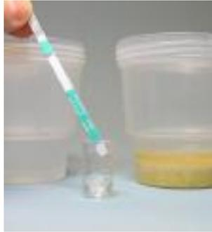
Figura 9: Colocando a tira no tubo de reação. Fonte:
