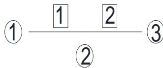
Figura 5.40 Malha de elementos finitos
