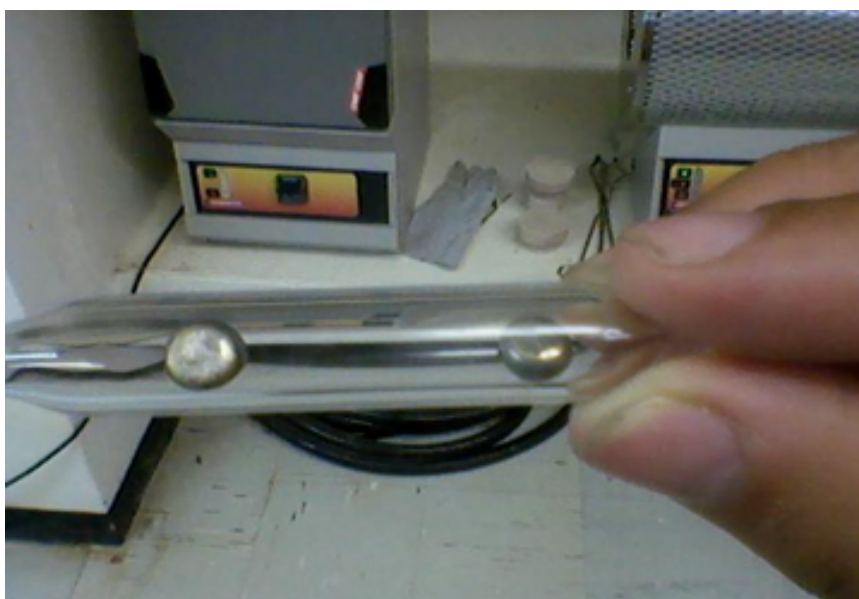
Figura 2.1: Na figura mostram-se os botões metálicos após a fusão e selados num tubo de quartzo para serem submetidos a tratamento térmico.
