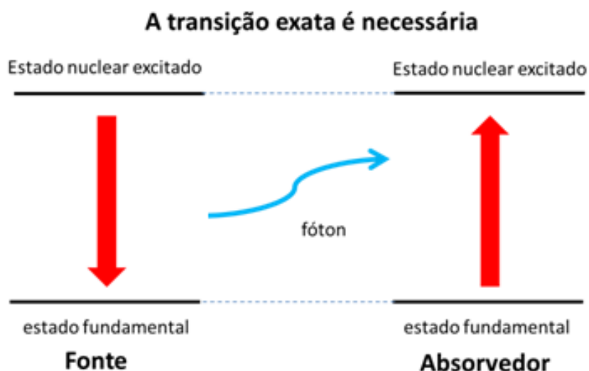
Figura 1.13: Diagrama no processo de emissão e absorção nuclear na fonte e no absorvedor necessário para o efeito Mössbauer.
