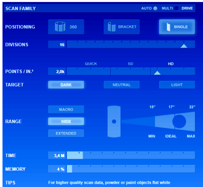
Figura 0.13 Tela de parâmetros do scanner laser pelo software ScanStudio sendo single; 17 divisões; 2000 pontos/polegada 2 ; modo wide
