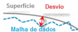
Figura 0.20 Desvios adotados entre a malha gerada e a superfície ajustada (NEXTENGINE, 2009)
