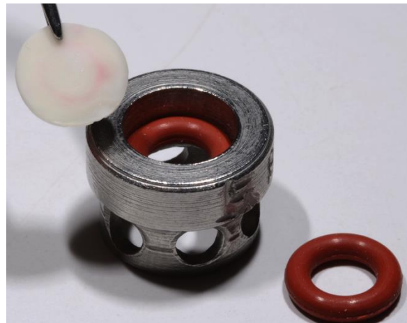
Figura 11 – Adaptação dos anéis de silicone no dispositivo.
