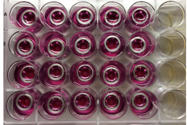
Figura 13 (B) – Preenchimento do compartimento com 1 mL de DMEM para possibilitar o plantio celular.
