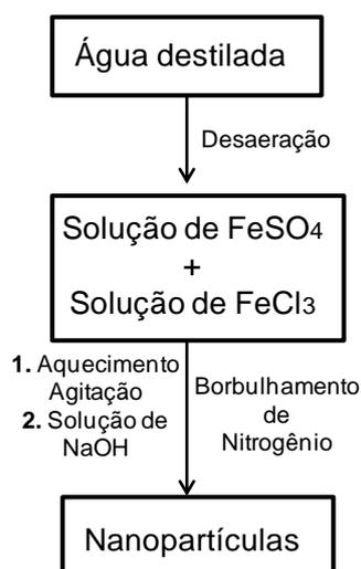
**Esquema 19:** Representação esquemática da síntese de nanopartículas de ferrita.
