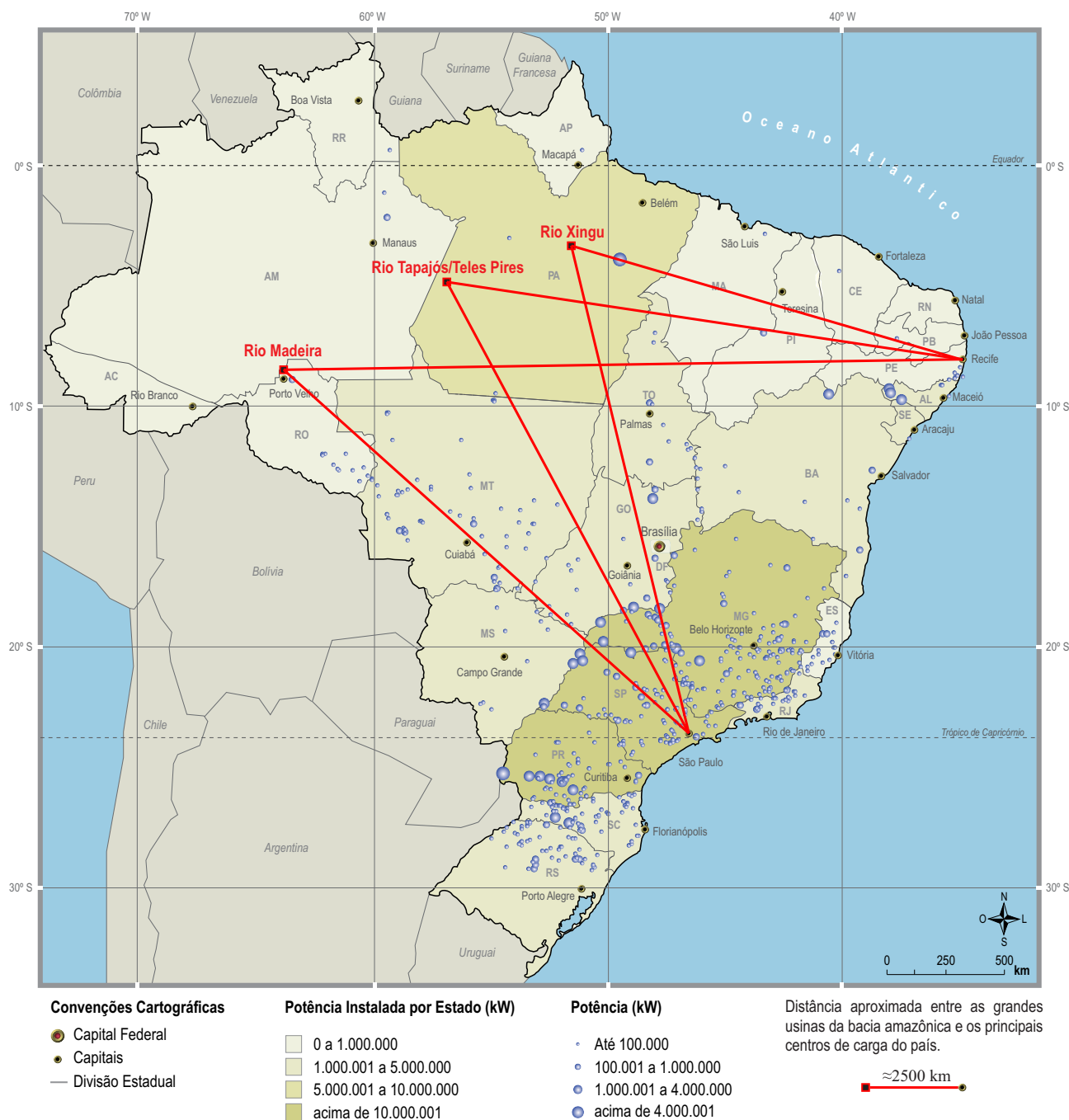
Figura 1.1: Distâncias entre as usinas na Bacia do Amazonas e os principais centros de carga brasileiros e distribuição geográfica das usinas hidrelétricas em operação no ano de 2008 (adaptação do Atlas de Energia Elétrica do Brasil (ANEEL, 2008a)).
