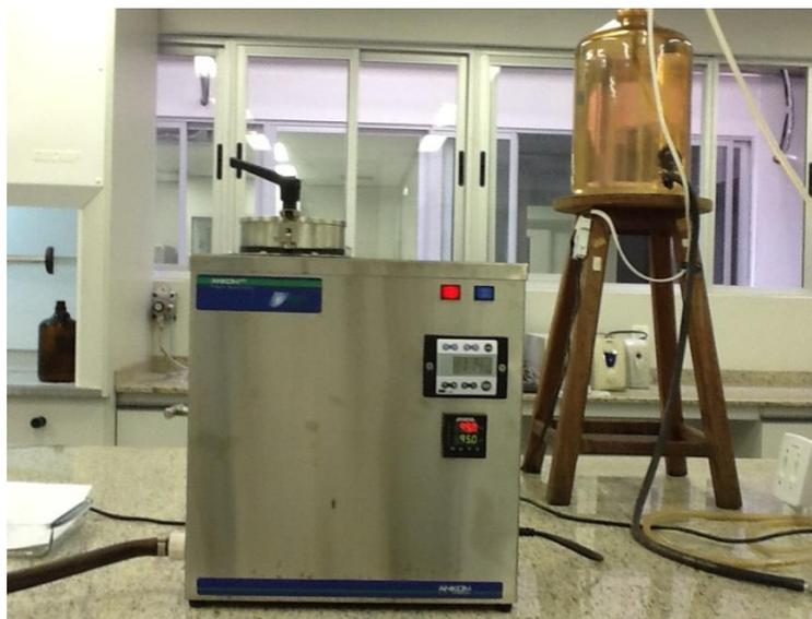
Figura 4.5 - Aparelho determinador de fibras. Fonte: Embrapa Cerrados, 2012.
