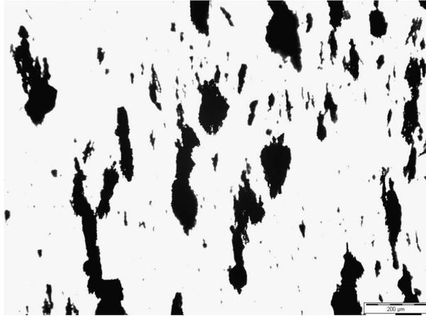
Figura 5.18: Imagem da estrutura da suspensão com  $\phi = 0,1\%$  com a presença de campo magnético.
