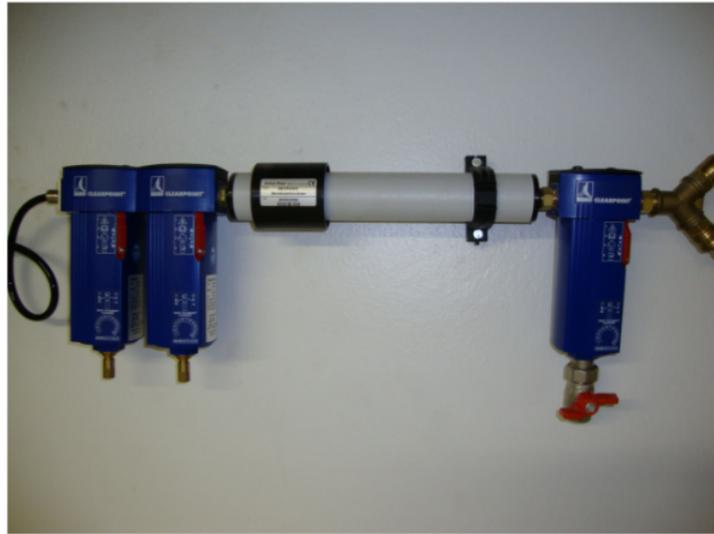
Figura 4.3: Filtros responsáveis pelo tratamento do ar que sai do compressor e se desloca até o reômetro MRC 301. (Laboratório de Microhidrodinâmica e Reologia - ENM - UnB)
