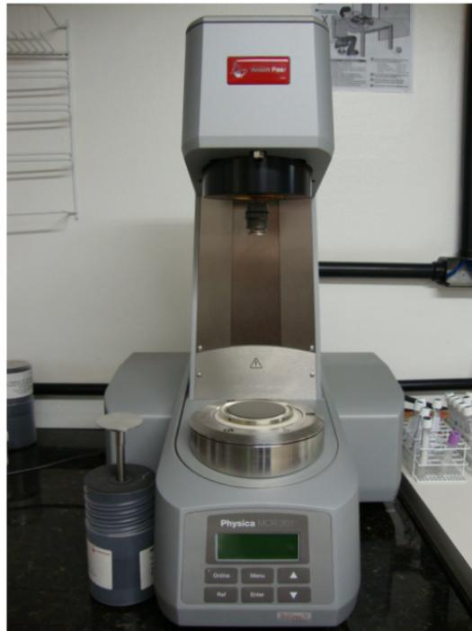
Figura 4.2: Reômetro MCR 301 da marca Anton Paar, que funciona baseado no princípio de escoamento entre disco rotativo e placa plana. (Laboratório de Microhidrodinâmica e Reologia - ENM - UnB)
