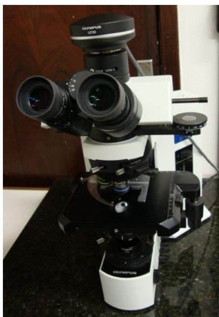
Figura 4.6: Microscópio ótico e câmera digital. (Laboratório de Microhidrodinâmica e Reologia - ENM - UnB)
