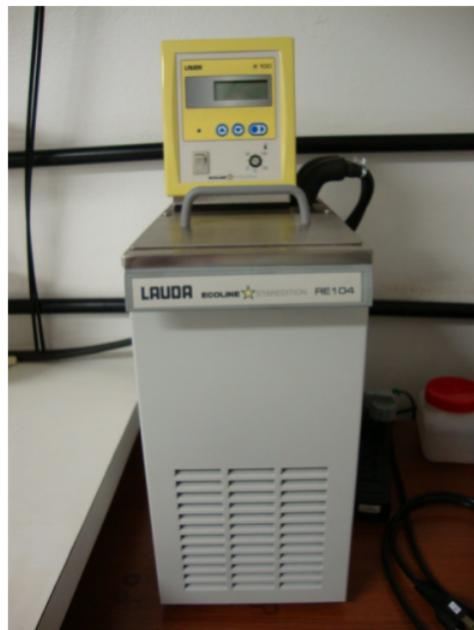
Figura 4.4: Equipamento responsável pelo controle da temperatura do fluido em estudo. (Laboratório de Microhidrodinâmica e Reologia - ENM - UnB)
