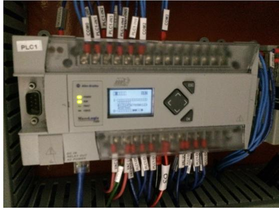
Figura 6.32: Controlador Lógico Programável (CLP) responsável pela integração dos sensores e atuadores da célula de Hele-Shaw.
