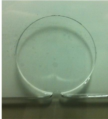
Figura II.4: Espaçador entre as placas planas verticais da célula de Hele-Shaw.
