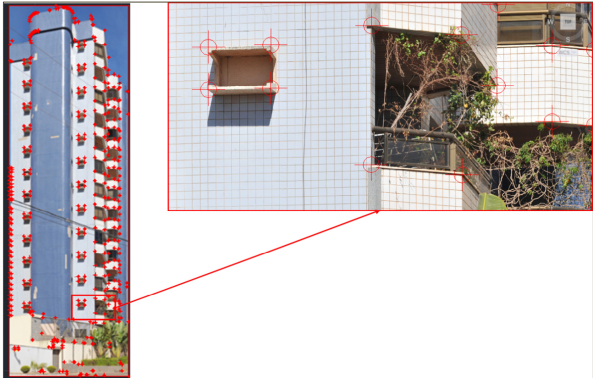
Figura 5. 9 – Identificação e marcação dos pontos de controle por meio do AutoCAD 2014
