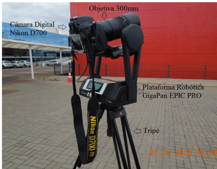
Figura 3. 2 – Um dos conjuntos de equipamentos, montado em campo, para a captação das imagens.
