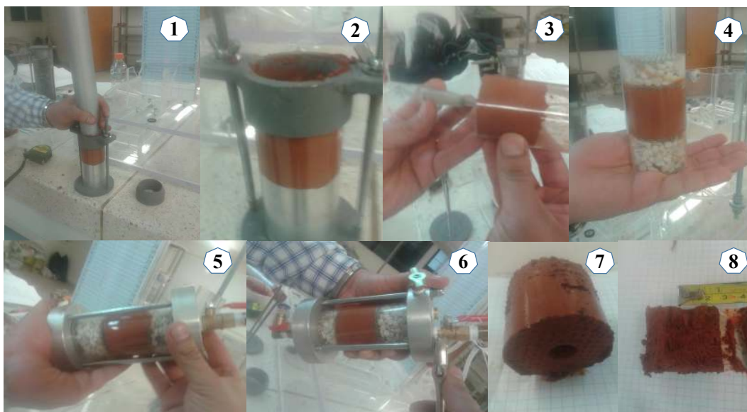
Figura 3.17: Processo do ensaio Pinhole para uma amostra a 3 m de profundidade
