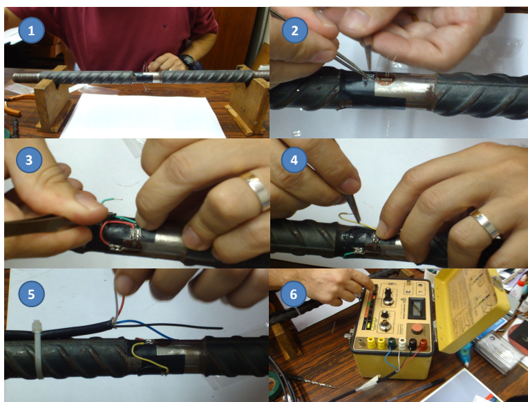
Figura 3.26: Instalação do strain gauge no grampo
